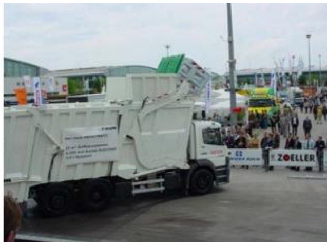
Слика 2.23. Возило за пражњење посуда са предње стране са фиксираним телом
