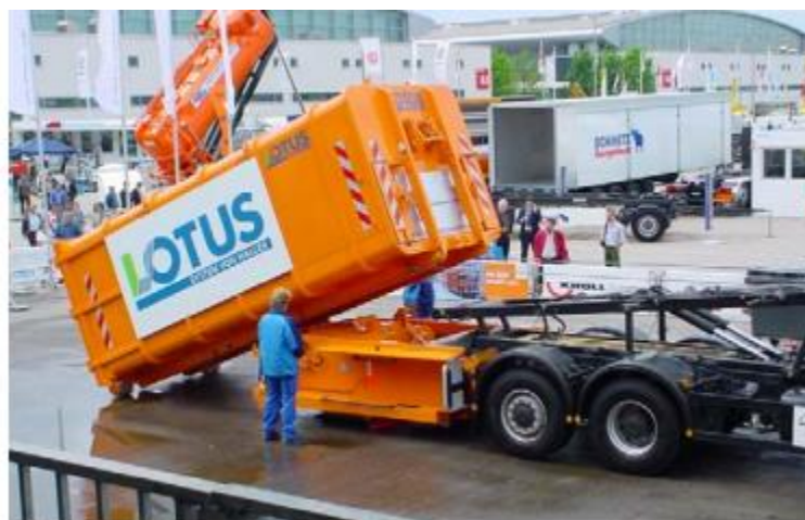
Слика 2.21. Специјална верзија возила са могућношћу замене система
