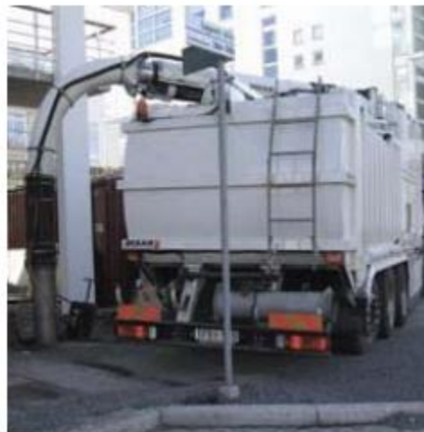
Слика 2.31. Вакуумско возило за сакупљање повезано са прикључном станицом за пражњење (сисање) складишта пнеуматског система за прикупљање отпада
