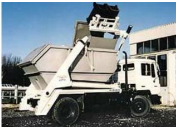
Слика 2.27. Специјална верзија за пражњење скип контејнера
