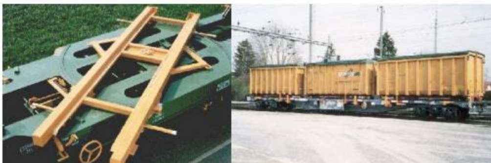
Слика 2.38. Железнички транспорт замењивог тела ACTS roll - off контејнера
