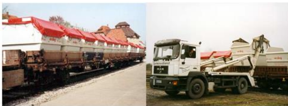
Слика 2.43. Систем користи аутоподизаче за железнички транспорт
