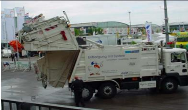
Слика 2.19. Двоструко тело возила за паралелно пражњење посуда са две раздвојене фракције отпада
