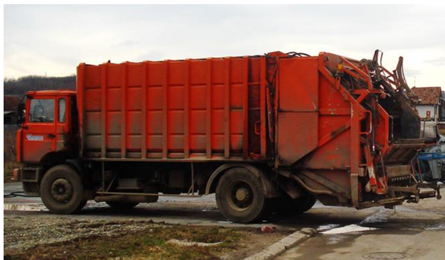
Слика 2.18. Основна верзија возила и дуални систем за подизање контејнера
