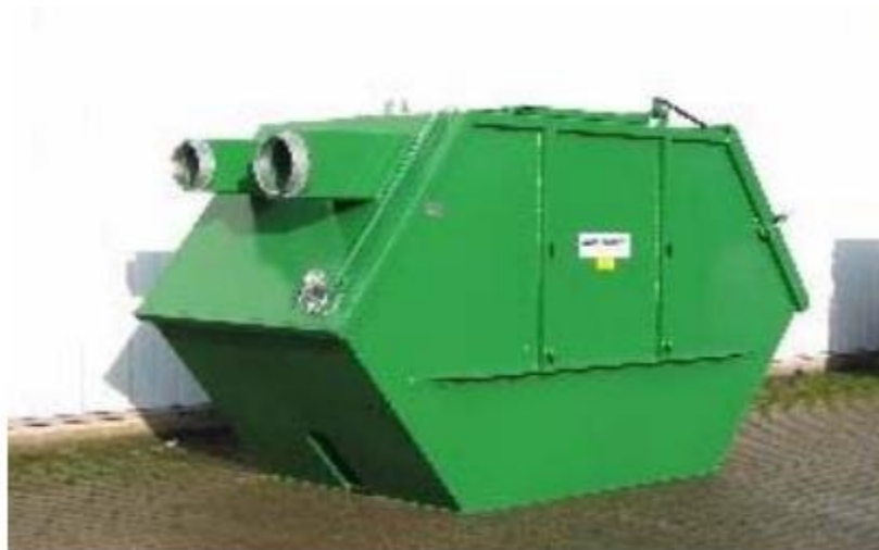
Слика 2.9. Верзија са одвајањем дрвене пиљевине од остатка отпада
