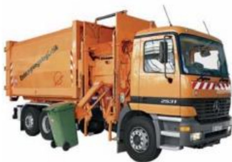
Слика 2.24. а) Каміон за прихватање посуда са бочне стране са промењивим задњим делом (телом) б) „Псеудо” тип са промењивим задњим делом
