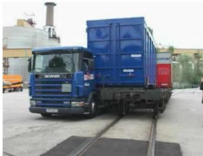
Слика 2.41. Хоризонтални претовар замењивог моста (BDF систем) са камоина на воз
