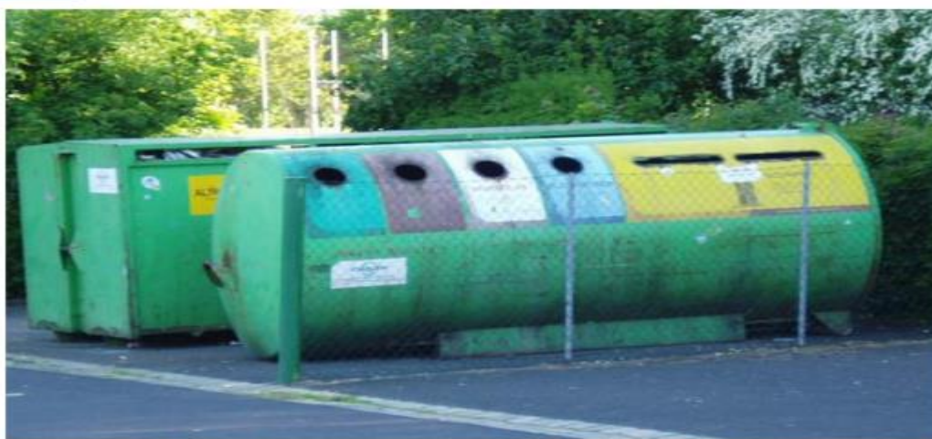
Слика 2.4. Затворени roll - off контејнери са отворима за сепарацију отпада
