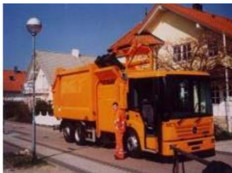
Слика 2.24. а) Каміон за прихватање посуда са бочне стране са промењивим задњим делом (телом) б) „Псеудо” тип са промењивим задњим делом
