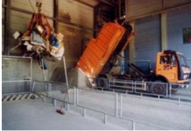
Слика 2.46. Трансфер станица са рампом за истовар возила за сакупљање и један багер за претовар отпада
