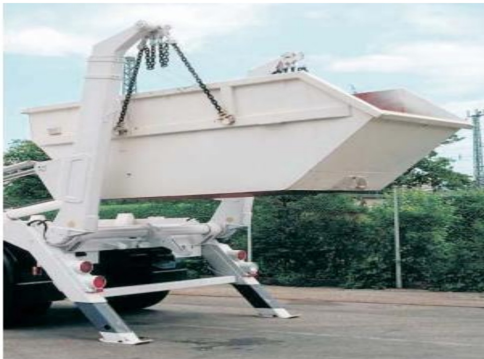
Слика 2.6. Основна верзија контејнера, са аутоподузачима на возилу за транспорт
