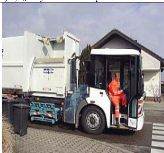
Слика 2.25. „Псеудо” тип возила за прихватање посуда са бочне стране интегрисан у тело конструкције
