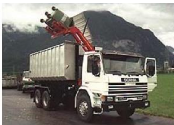
Слика 2.26. Возило за прихватање посуда са бочне стране без интегрисаног система за сабијање отпада (возило за превоз стакла)
