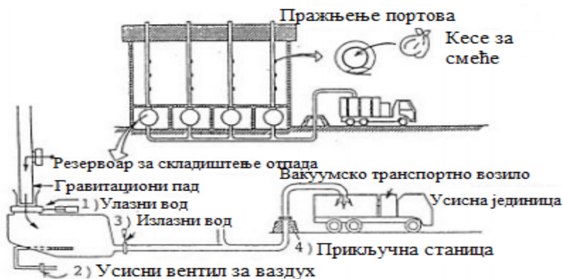
Слика 2.28. Стационаран пнеуматски систем за прикупљање отпада
