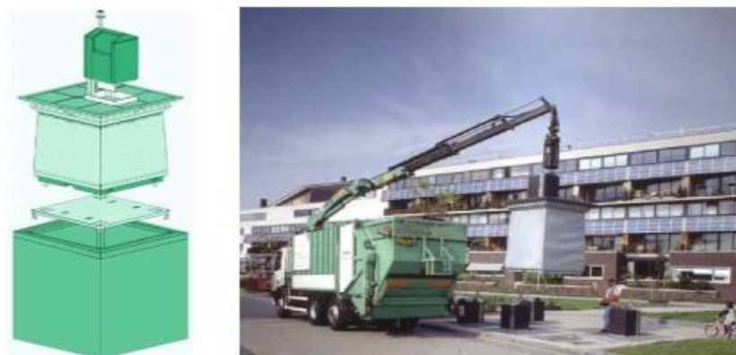
Слика 2.13. Принцип функционисања стандардне верзије станице за сакупљање отпада
