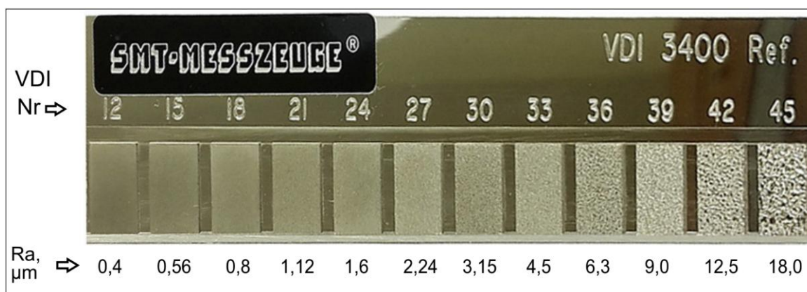
Слика 3.25 Еталон за визуелну оцјену храпавости обрађене површине
