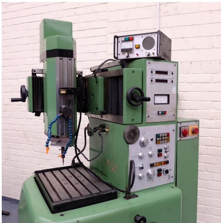
Слика 3.41 Изглед радног стола, конзоле и носача алата HURCO 425E
