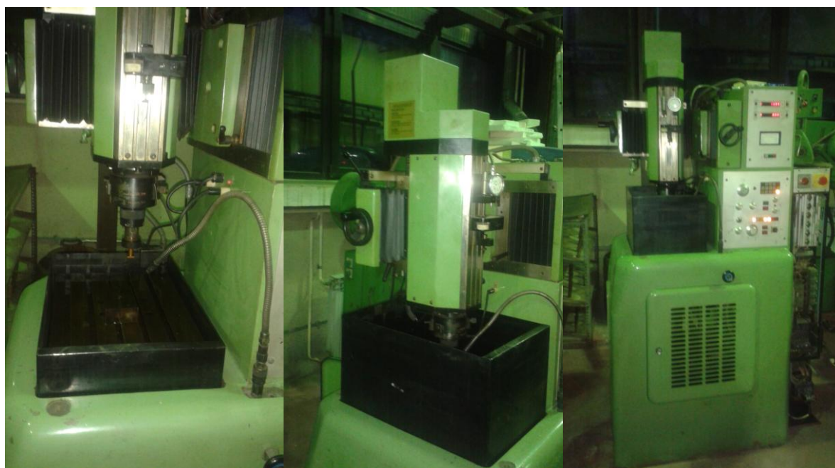
Слика 3.42 Приказ подизања радне каде и потапања радног комада на машини HURCO 425E
