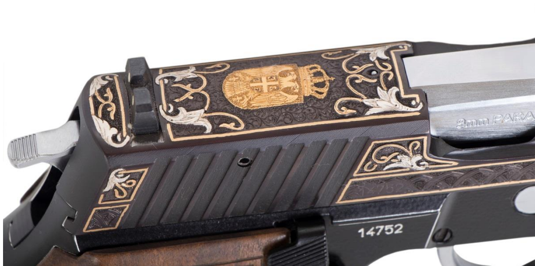
Слика 1.7: Ручна гравура и линијска интарзија са утиснутом сребрном и златном жицом на пиштољу ЦЗ 999 [17].
