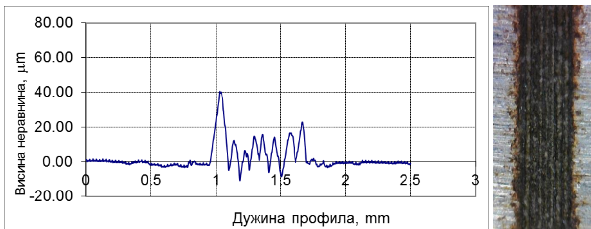
Слика 4.8: Профил топографије површине узорка 8 од челика
