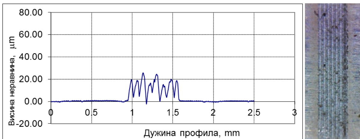
Слика 4.31: Профил топографије површине узорка 3 од алуминијума
