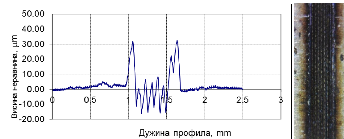
Слика 4.24: Профил топографије површине узорка 12 од месинга
