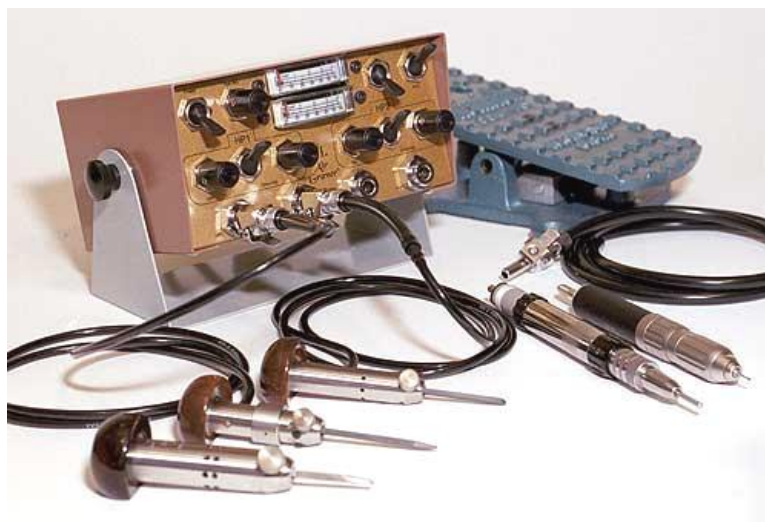
Слика 1.3: Опрема за пнеуматско гравирање старије производње [13].
