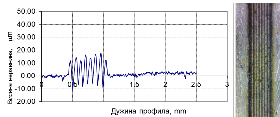
Слика 4.18: Профил топографије површине узорка 6 од месинга
