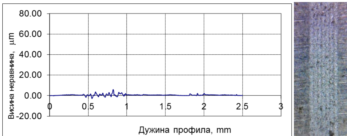
Слика 4.29: Профил топографије површине узорка 1 од алуминијума
