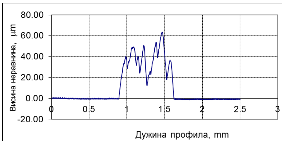
Слика 4.35: Профил топографије површине узорка 7 од алуминијума
