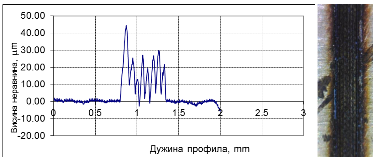
Слика 4.23: Профил топографије површине узорка 11 од месинга
