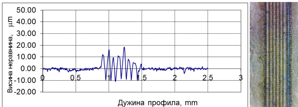
Слика 4.14: Профил топографије површине узорка 2 од месинга
