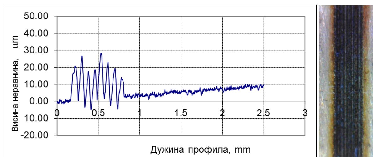
Слика 4.19: Профил топографије површине узорка 7 од месинга
