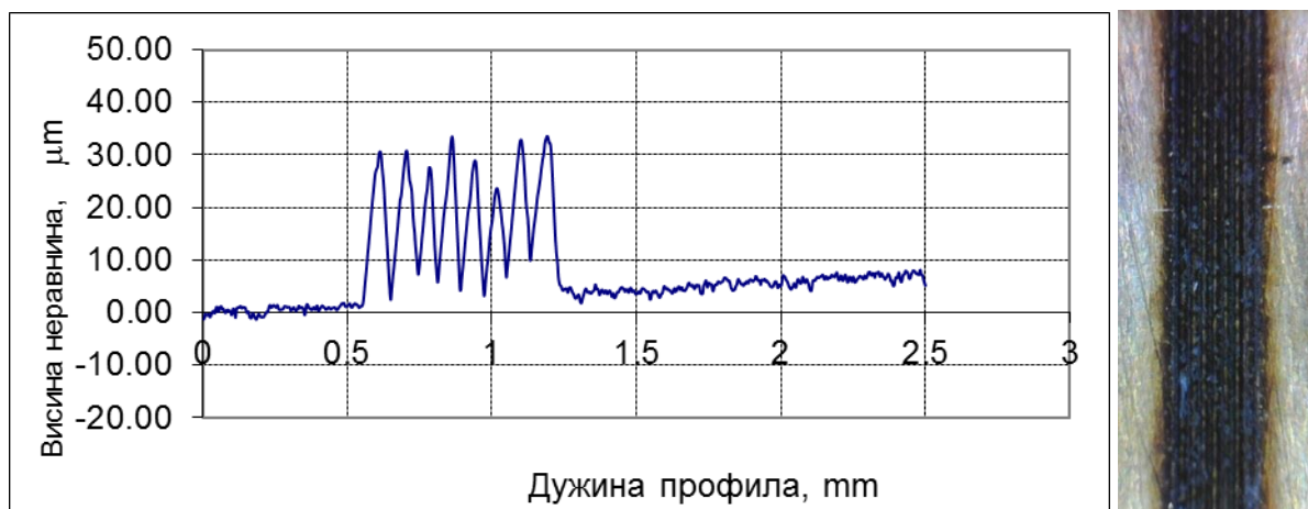
Слика 4.21: Профил топографије површине узорка 9 од месинга
