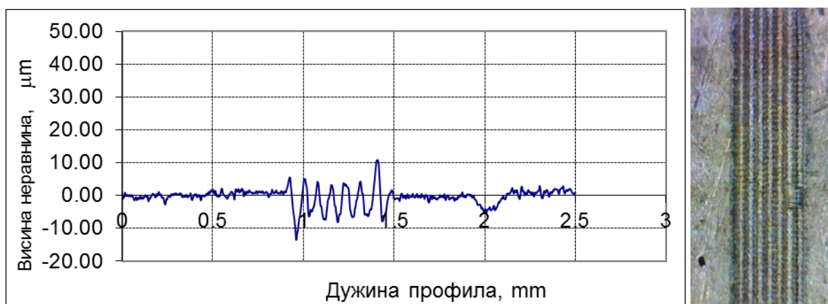
Слика 4.13: Профил топографије површине узорка 1 од месинга
