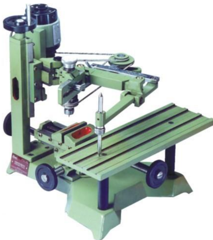
Слика 2.2: Пантограф са електричним погоном [19].
