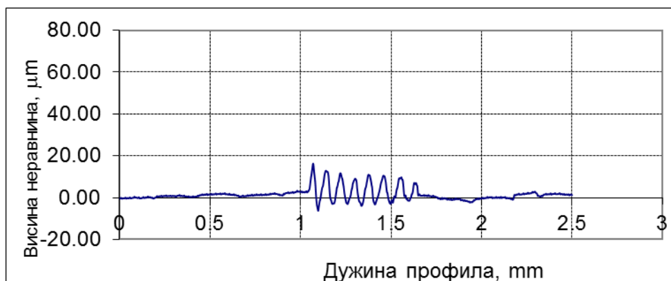
Слика 4.1: Профил топографије површине узорка 1 од челика
