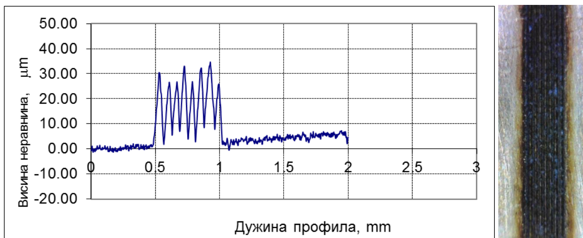
Слика 4.20: Профил топографије површине узорка 8 од месинга
