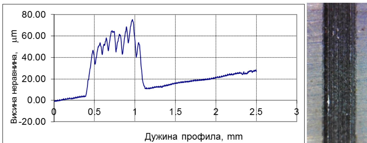
Слика 4.33: Профил топографије површине узорка 5 од алуминијума
