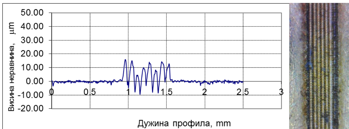
Слика 4.15: Профил топографије површине узорка 3 од месинга
