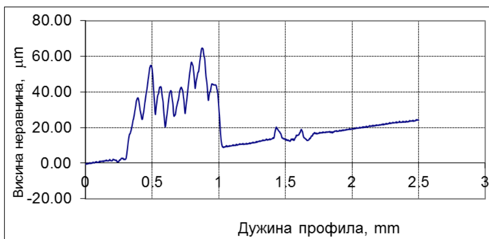
Слика 4.37: Профил топографије површине узорка 9 од алуминијума
