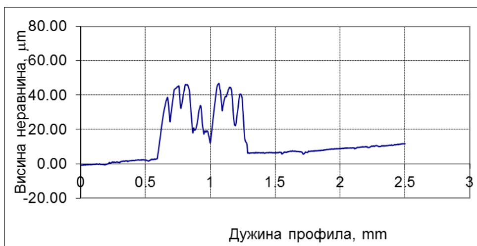
Слика 4.36: Профил топографије површине узорка 8 од алуминијума
