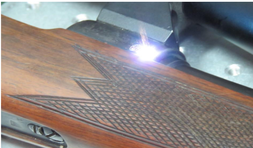
Слика 2.6: Гравирање жига на оружју [сопствена слика].
