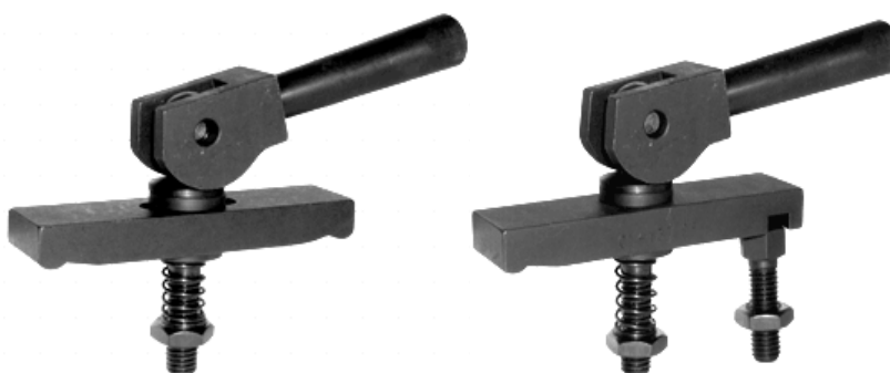
Слика 2.25.б. Пример стезања ексцентром
