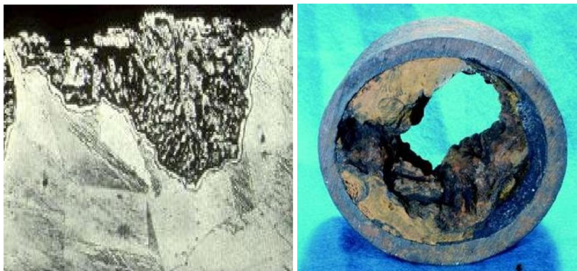
а) б) а) Растварање Zn из месинга; б) Раств. Fe из сивог ливеног гвожђа (3% C) Слика 2.20 Типични примери селективне корозије
