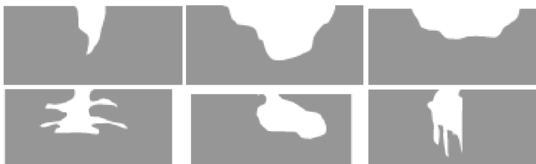
Слика 2.11 Различити облици јамица на попречном пресеку
