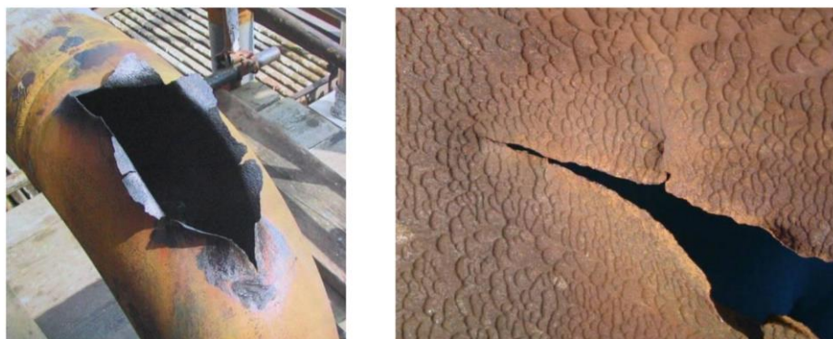
Слика 2.25 Последица ерозионе корозије приликом оштећења цевовода за транспорт нафте
