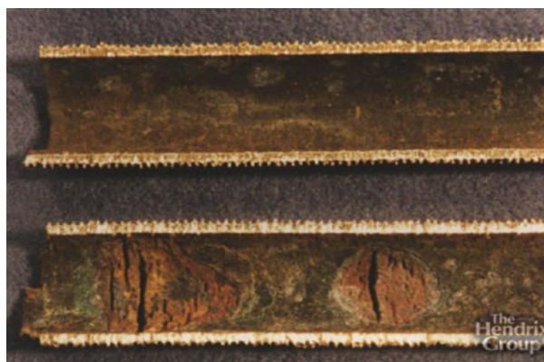
Слика 3.9 Селективна корозија месинга
