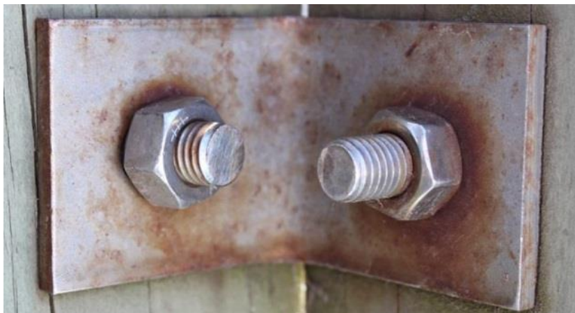
Слика 2.13 Пример контактне корозије између поцинкованог челика (завртња и навртке) и челичног лима
