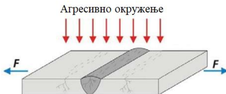
Слика 2.24 Узрочници напонске корозије
