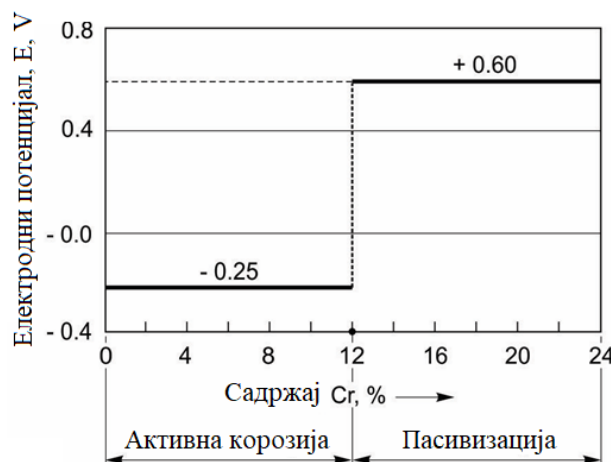
Слика 2.18 Зависност стандардног потенцијала хромових челика од садржаја Cr у чврстом раствору гвожђа
