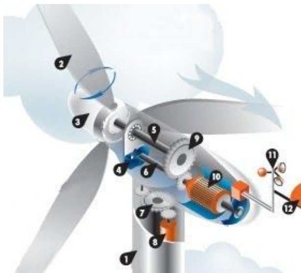
Слика 3. Делови ветроелектране, [9]
