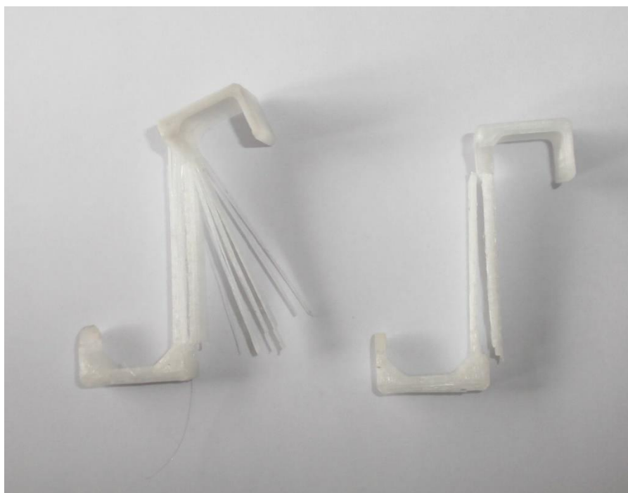
Слика 54. Лом материјала код ојачане (лево) и неојачане (десно) куке
