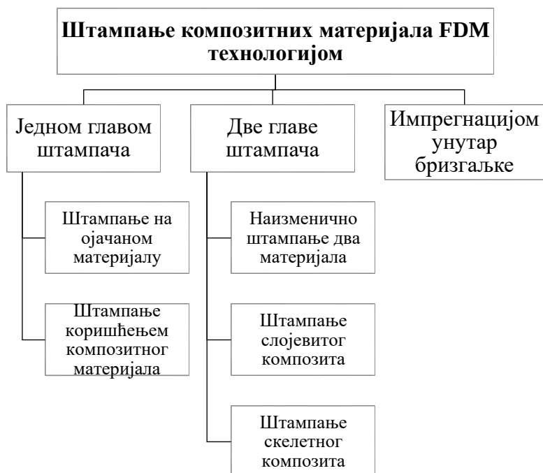
Слика 16. Шематски приказ поделе FDM штампе композита према врсти главе штампача [10]
