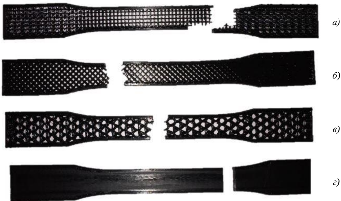
Слика 10. Визуелни прикази преломе епрувете различитих типова језгра: а) правоугаони, б) дијамантски, в) саħе, г) пун материјал [5]
