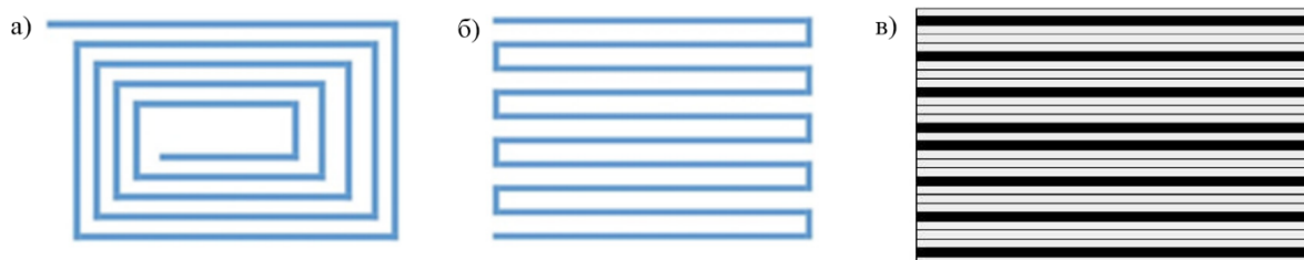
Слика 21. Шематски прикази штампне узорака а) концентрична орјентација б) изотропна орјентација в) попречни пресек [12]
