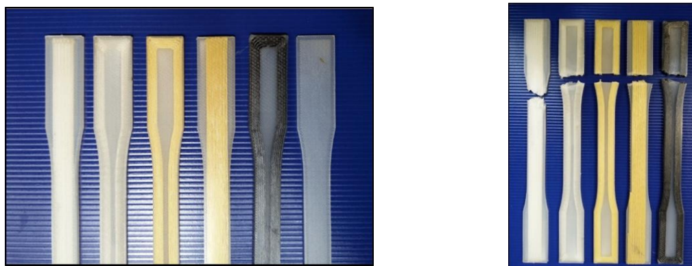
Слика 22. Епрувете за испитивање на затезање, пре испитивања (лево) и након (десно) [12]
