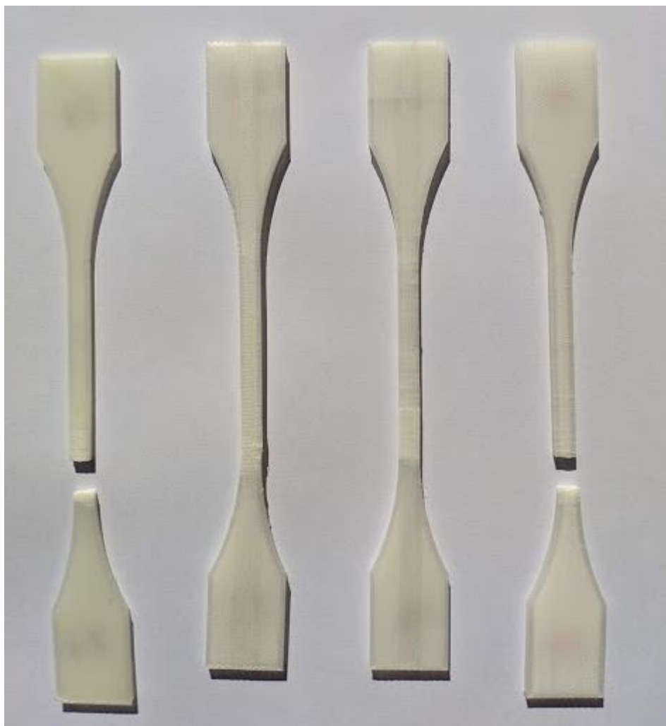
Слика 39. Епрувете након испитивања на затезање, са лева на десно: [45,135] пун материјал; [45,135] ојачана; [0,90] ојачана; [0,90] пун материјал;
