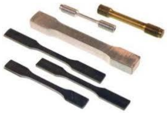
а) Стандардни облици епрувета/узорака – цилиндрични и плочасти
