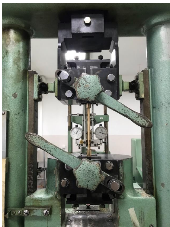
Слика 4.5 Изглед епрувете у чељустима машине за испитивање
