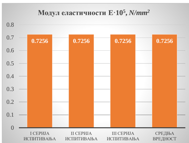
График 3 а) Вредности издужења и б) модула еластичности испитиване епрувете од алуминијума
