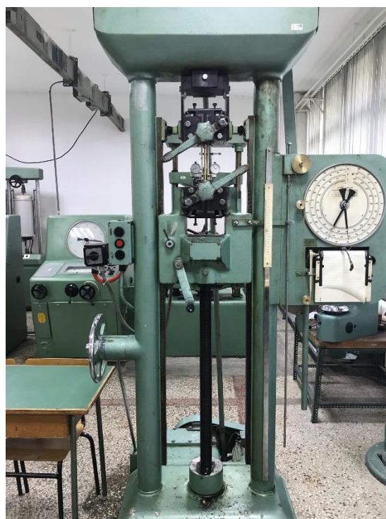
Слика 4.5 Изглед епрувете у чељустима машине за испитивање
