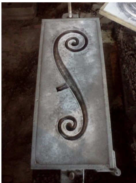
Слика 5.6 Калуп за ливење једног од различитих облика од алуминијума
