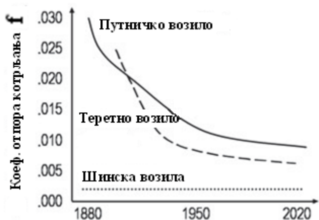
Слика 34. Прогресија коеф. отпора котрљања путничких и теретних возила за последњих 120 година [3]
