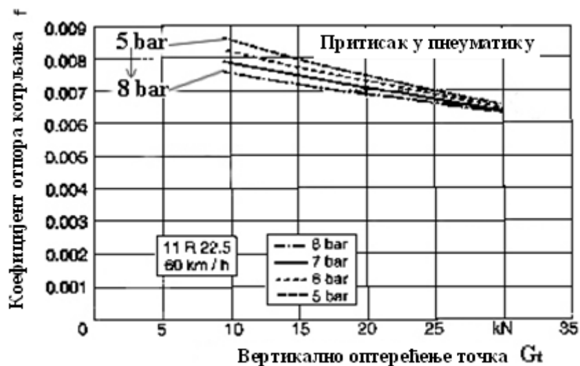
Слика 22. Зависност коефицијента отпора котрљању од оптерећења точка и притиска у пнеуматикама [5]
