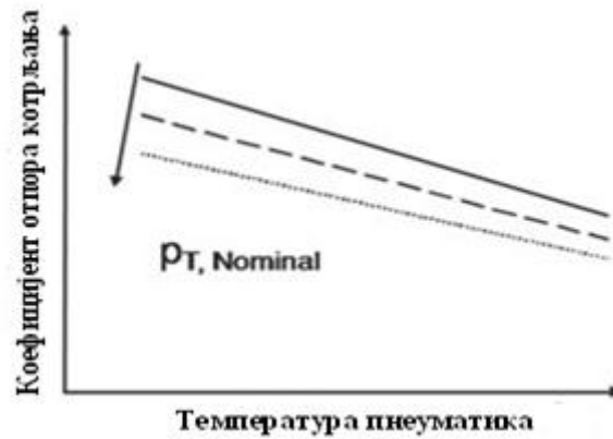
Слика 30. Однос између коефицијента отпора котрљања и температуре пнеуматика са додатним утицајем номиналног притиска у пнеуматичима [3]
