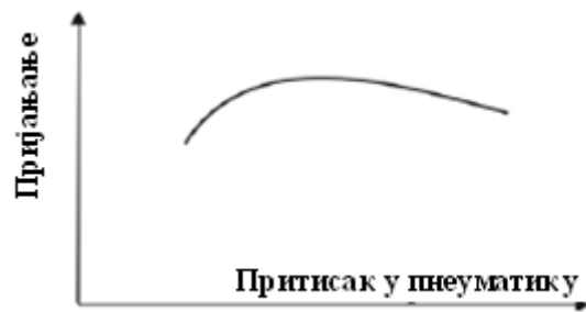
Слика 18. Квалитативан облик зависности пријањања од притиска у пнеуматику [3]
