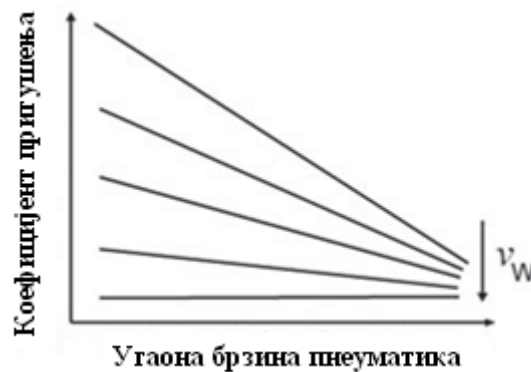
Слика 27. Коефицијент пригушења као функција угаоне брзине точка возила [3]
