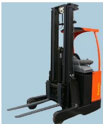
Слика 4.8. Виљушкар који за подизање терета користи компоненте водне хидраулике [13]
