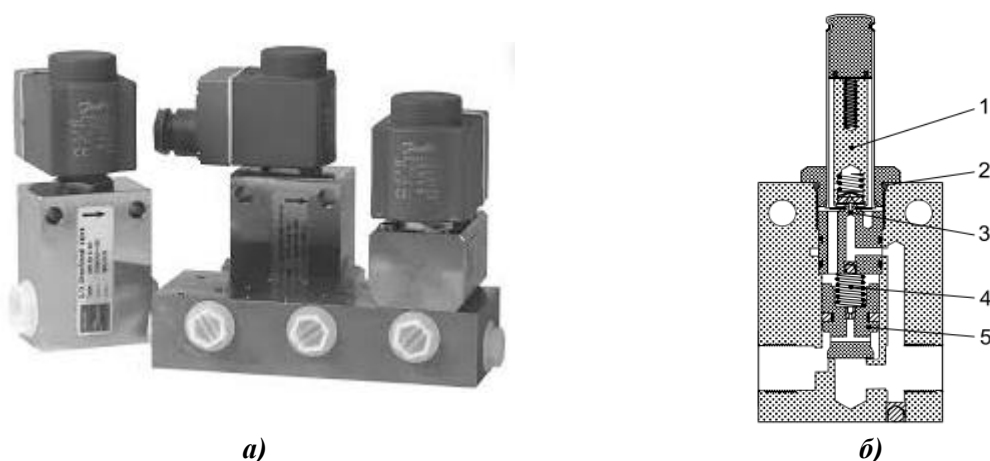
Слика 5.9. а) Danfoss двоположајни разводни вентил са два прикључка VDH 60 E, б) попречни пресек: 1. арматура; 2. о прстен, 3. отвор, 4. опруга, 5. калем [18]
