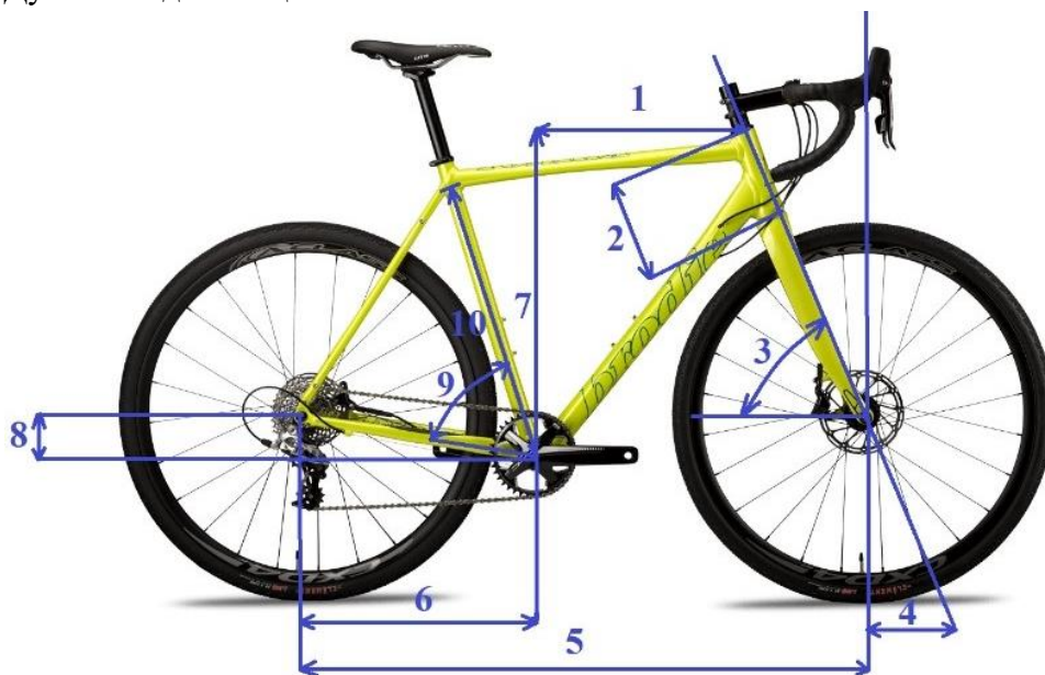
Слика 25. Основне димензије и углови рама бицикла, адаптирано, [39]
