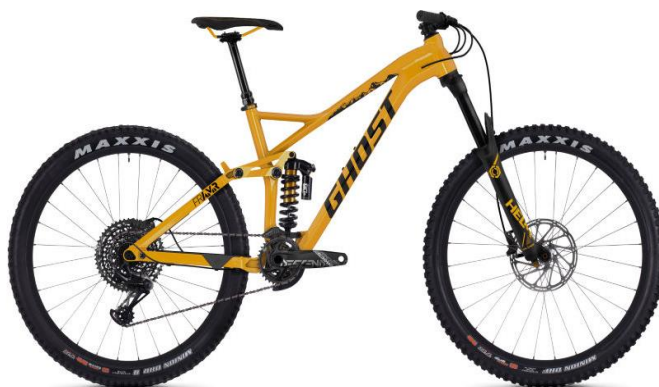
Слика 22. Планински бицикл са задњим амортизером, [35]
