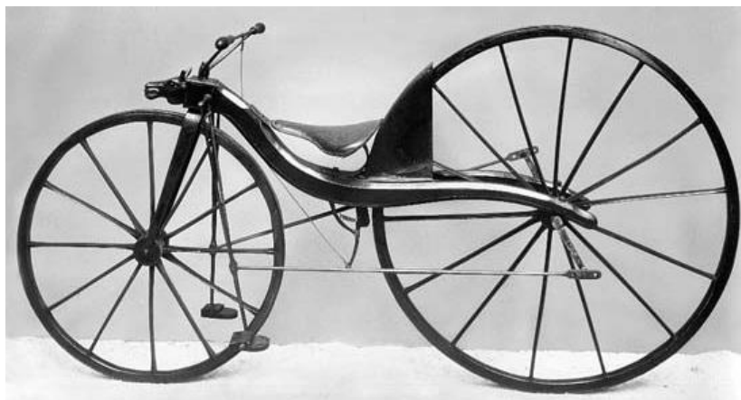
Слика 7. Мекмиланов модел бицикла, [15]
