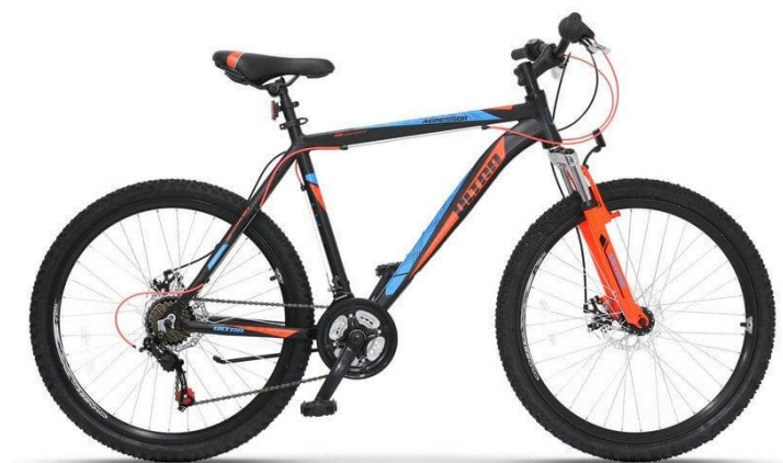
Слика 21. Планински бицикл без задњег амортизера, [34]
