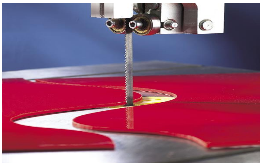
Слика 4.11. Изглед и поступак сечења полимера тракастом тестером. [16]
