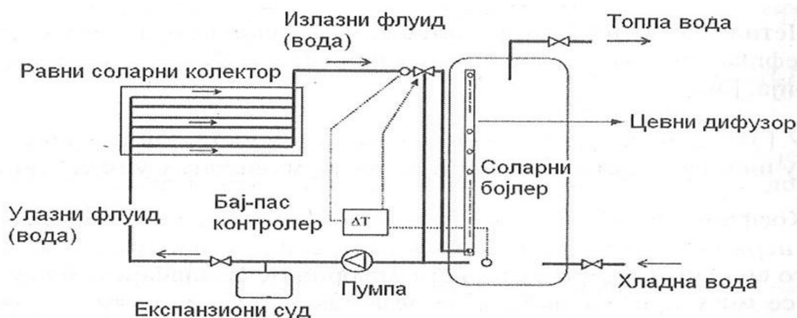
Слика 2.1: Соларни систем за припрему топле воде у домаћинству
