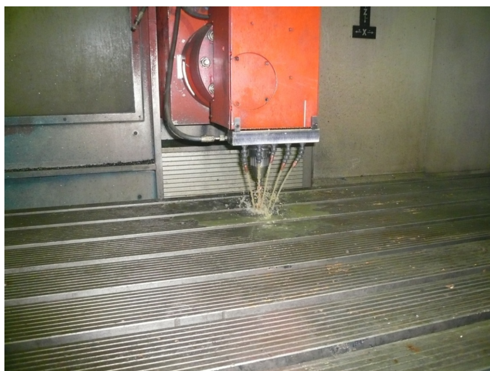
Слика 65. Израда отвора (бушење)
