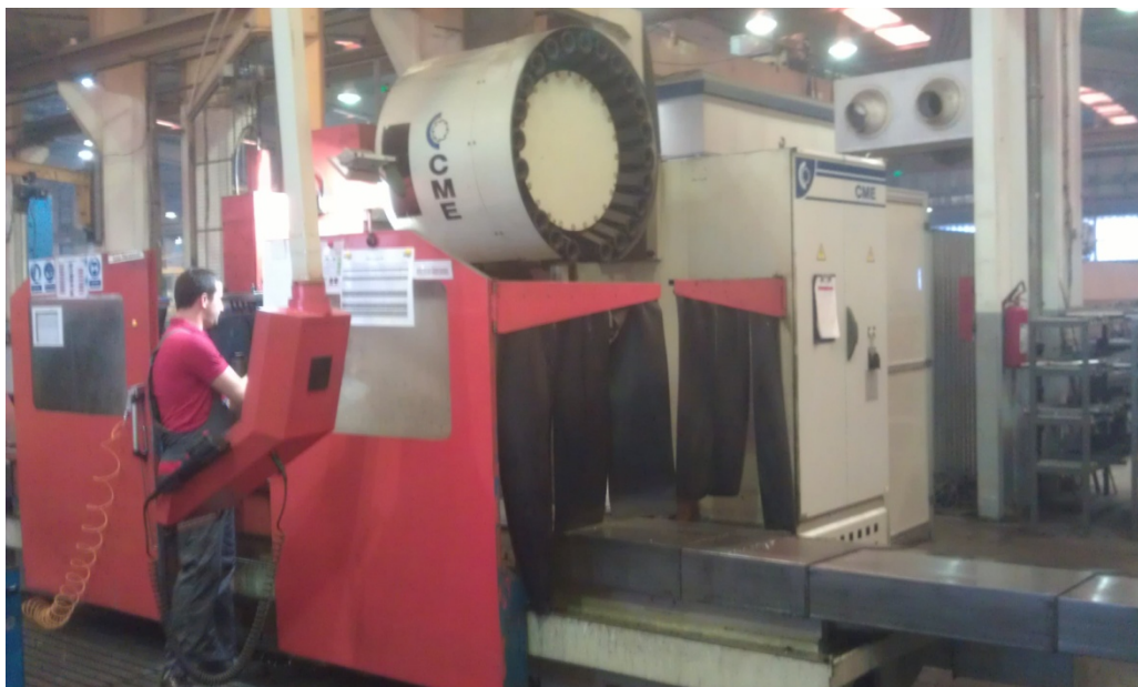
Слика 11. Вертикална глодалица CME FS4 -450
