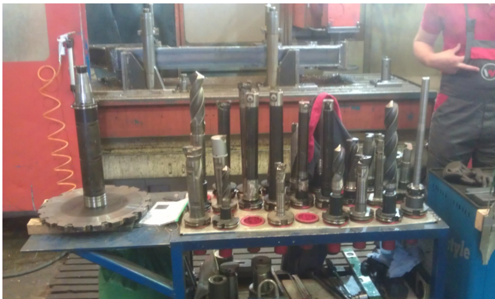
Слика 28. Резни алати са Sandvik диском Ø315
