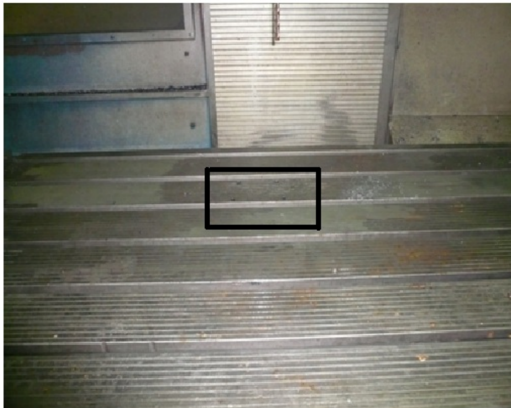
Слика 66. Изглед радног стола након бушења
