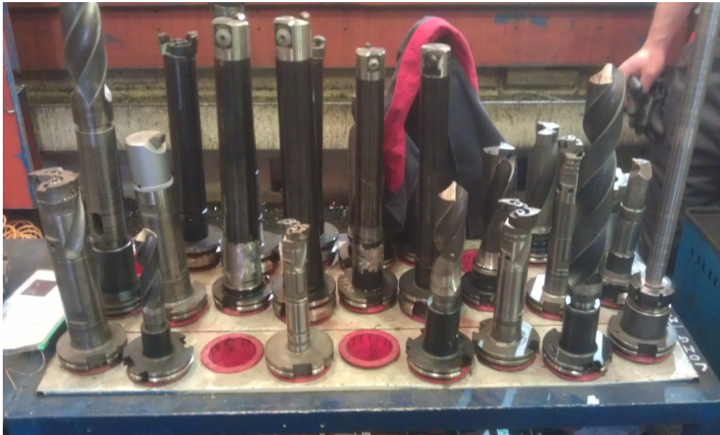
Слика 27. Резни алати произвођача Sandvik и HSS
