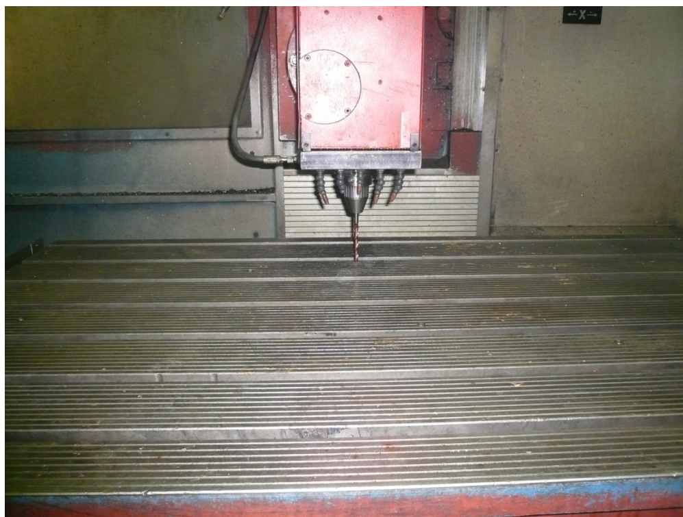
Слика 64. Чишћење основног радног стола
