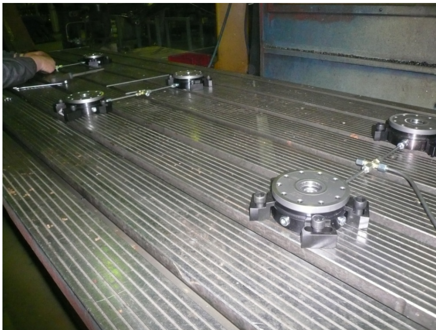
Слика 71. Изглед базних кућишта пинова након повезивања хидрауличке инсталације
