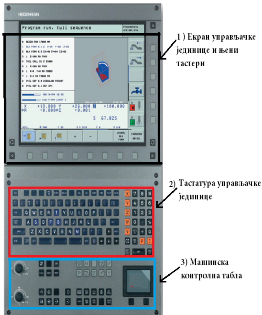
Слика 16. Командна табла HEIDENHAIN TNC i530 управљачке јединице [7]
