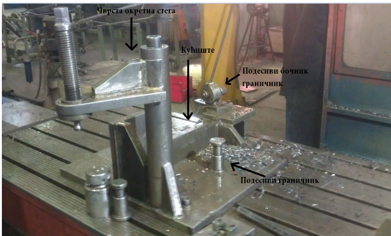
Слика 31. Кућиште са чврстом окретном стегом, подесивим бочним граничником и подесивим граничником (слушкиња).
