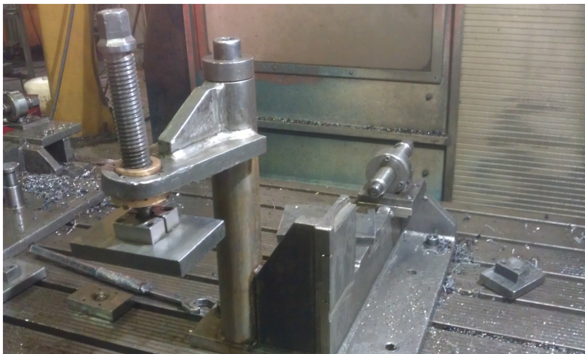
Слика 32. Кућиште са подесивом окретном стегом и подесивим бочним граничником
