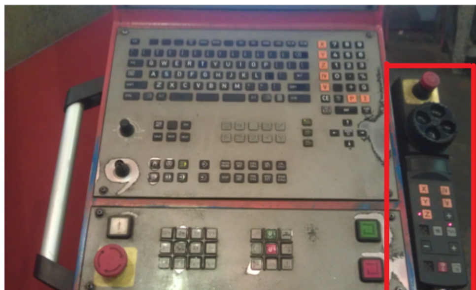
Слика 13. Управљачка јединица HAIDENHAIN са преносним командном таблом за ручно управљање HAIDENHAIN HR- 410
