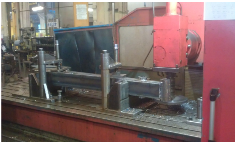
Слика 35. Позиција радног комада на радном столу након стезања
