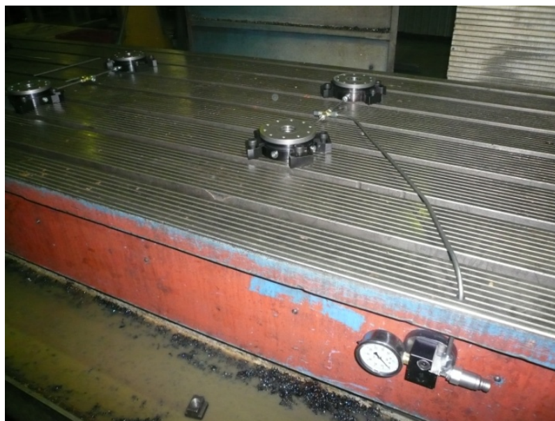
Слика 70. Изглед базних кућишта пинова након стезања
