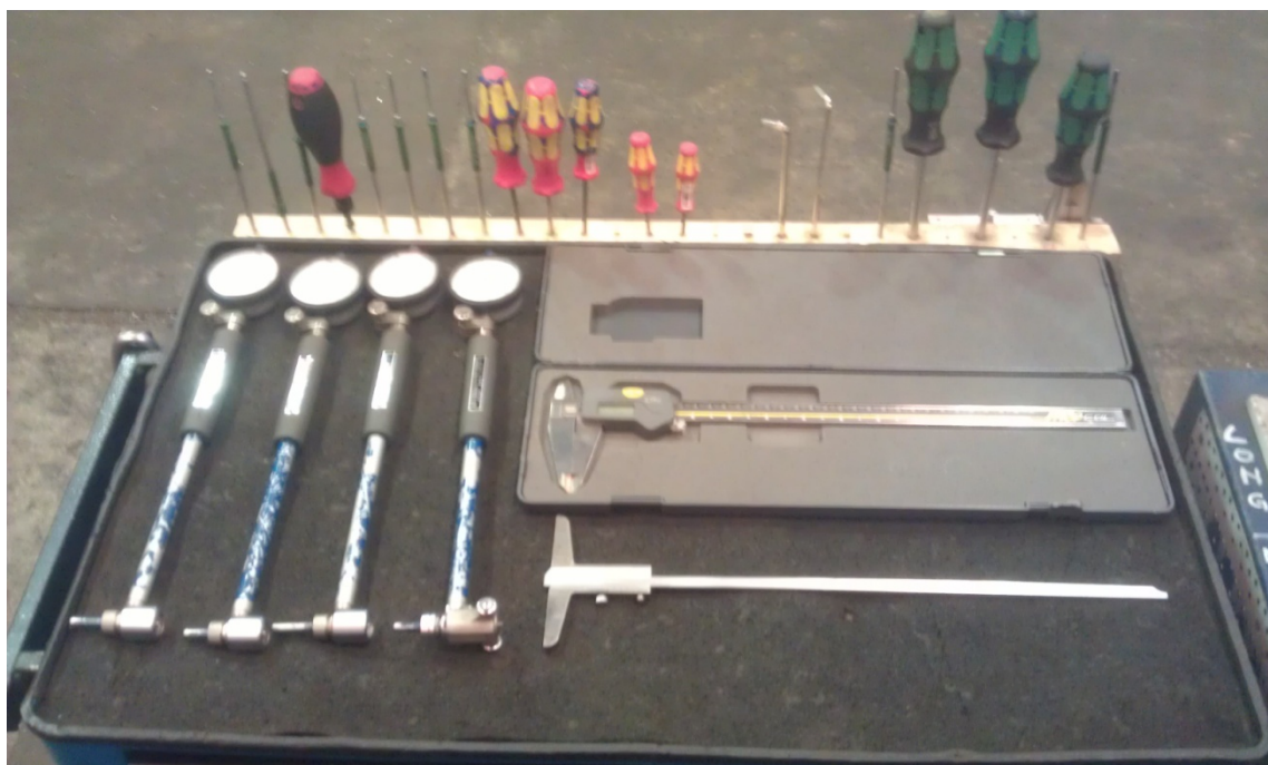
Слика 29. Помична кљунаста и дигитална мерила
