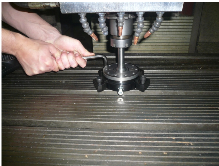
Слика 69. Затежање базних кућишта пинова
