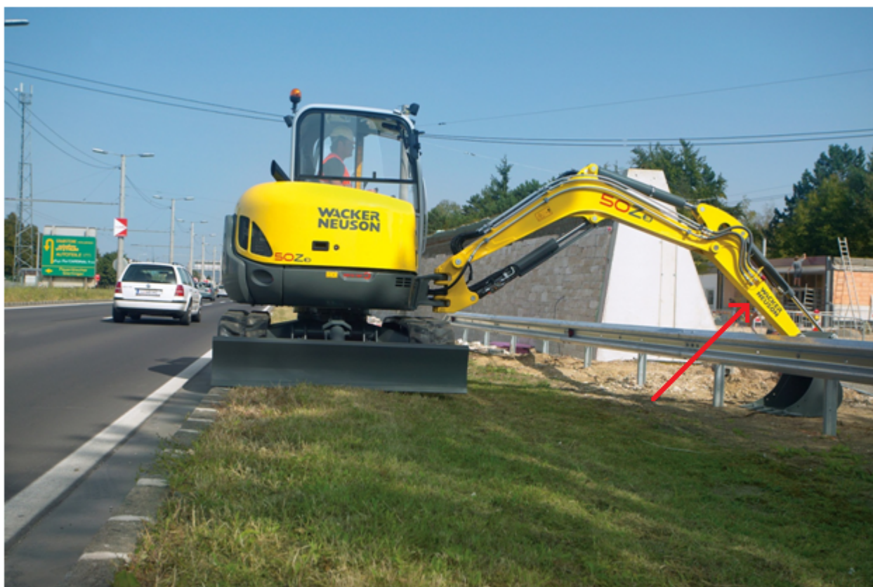
Слика 20. Горња рука за више типова багера произвођача Wacker Neuson [10]
