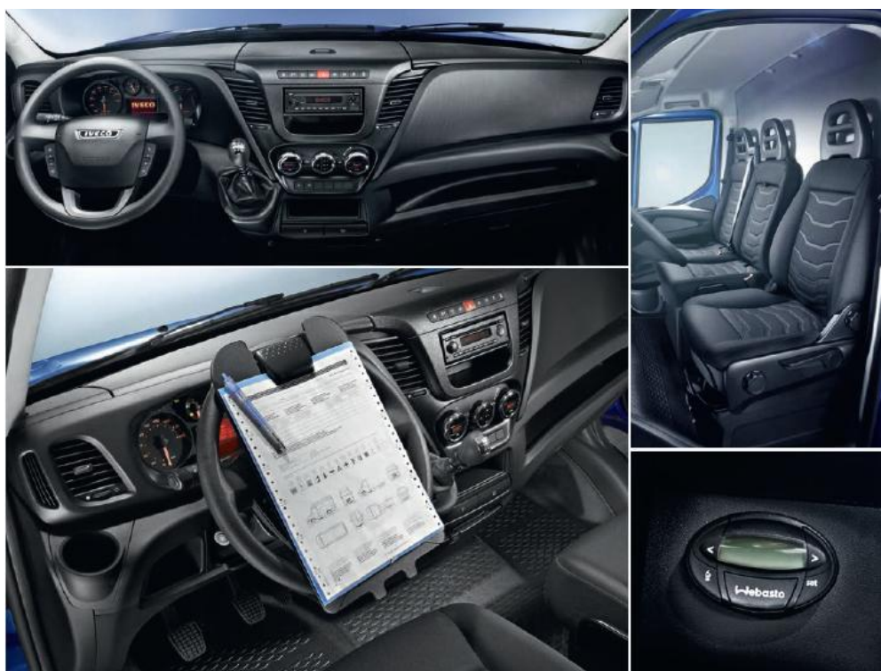
Слика 8.19. Ентеријер возила Iveco Daily Plus као полазна основа за израду и опремање возачке кабине санитетског возила [33]
