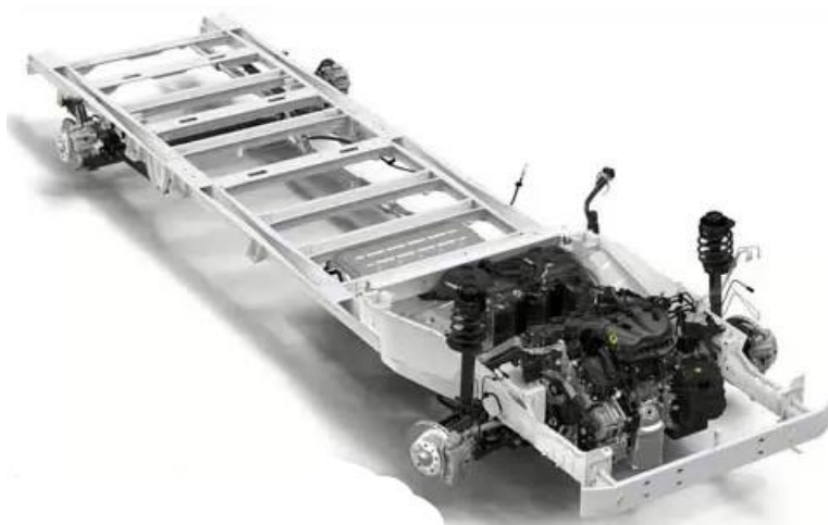
Слика 7.2. Подвожје – шасија возила Ram ProMaster са предњом погонском осовином [30]
