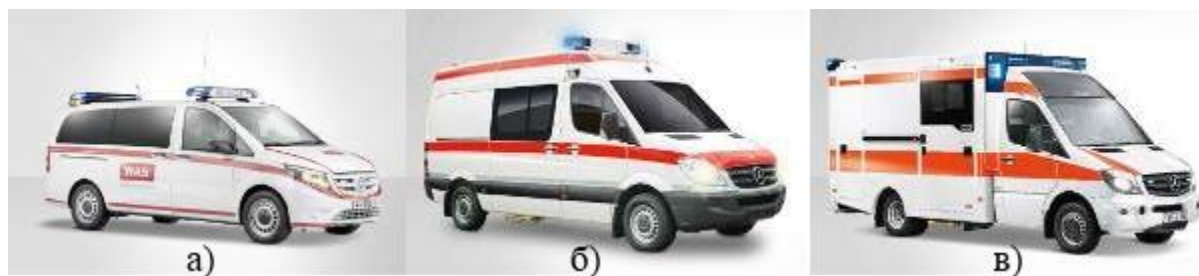
Слика 2.5. Категорије санитарских возила у Европи: а) тип А, б) тип В, в) тип С [13]
