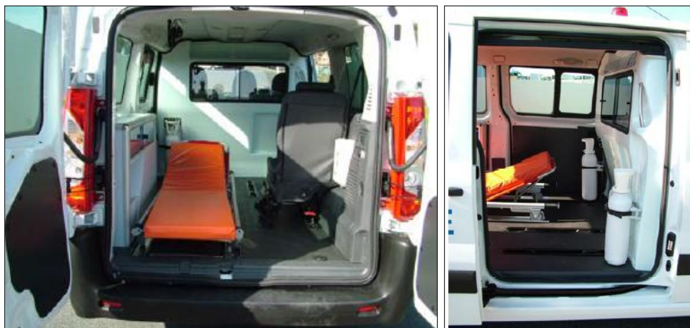
Слика 3.12. Унутрашњост санитарског возила Peugeot Expert (тип А2) са медицинском опремом [24]
