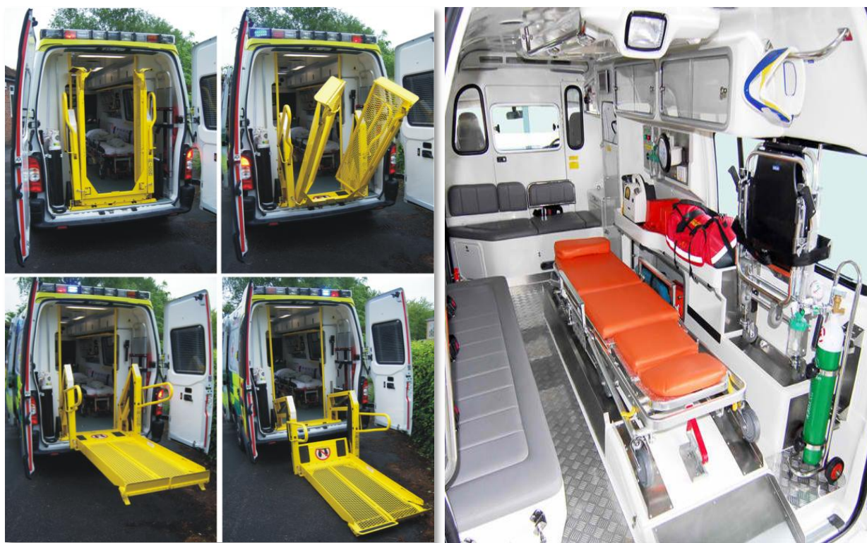
Слика 2.10. Лево: хидрауличка рампа за уношење носила у санитарско возил; Десно: ентеријер (са пратећом опремом) савременог санитарског возила за мобилну интензивну негу [15]
