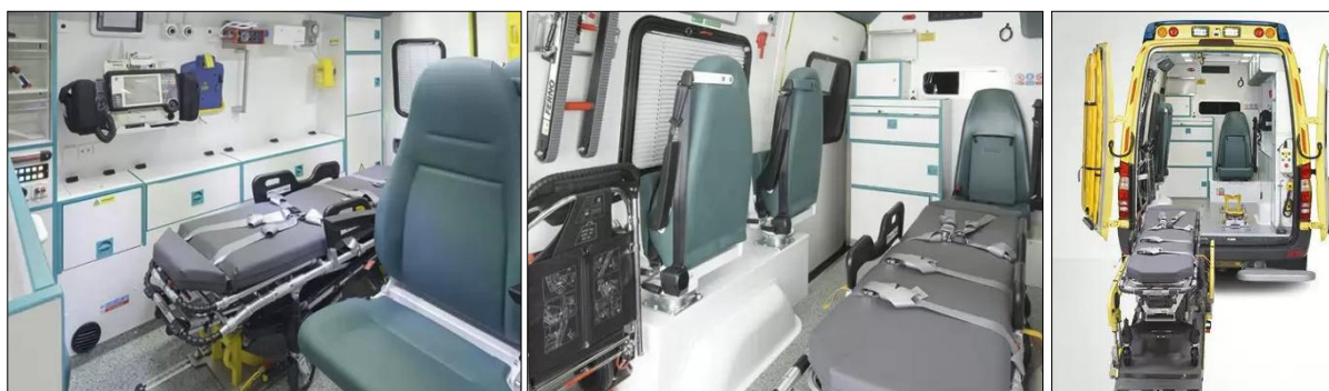
Слика 3.2. Унутрашњост санитарског возила MB Sprinter (мин В) са медицинском опремом [13]
