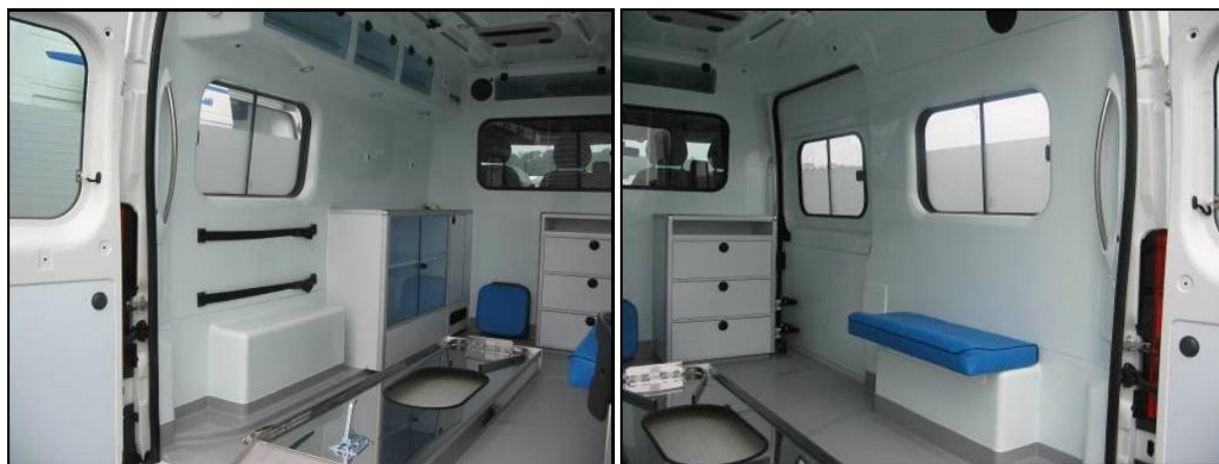
Слика 3.8. Унутрашњост санитарског возила Peugeot Boxer (тип В) [23]
