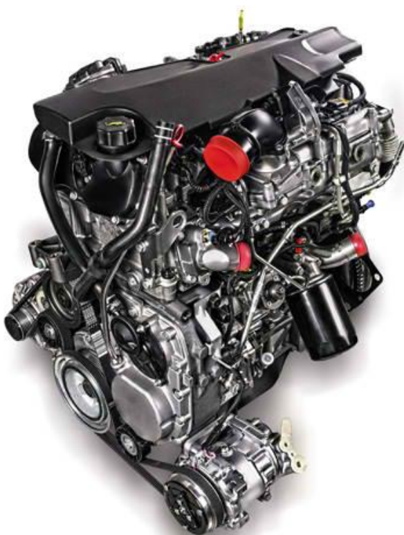
Слика 8.4. Лево: дизел мотор FTP 180 Multijet, Десно: дијаграм снаге и обртног момента [44]
