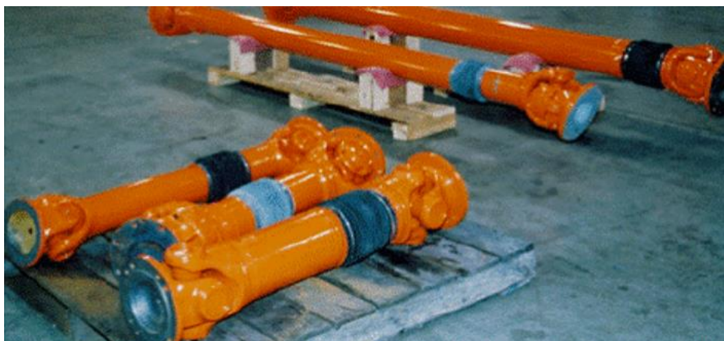
Слика 7.1 Положај карданских вратила при складиштењу, [17]
