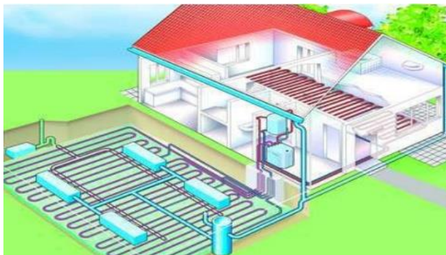
Слика 6. Пример коришћења геотермалне енергије (дизалица топлоте која је спојена на систем подног грејања) [10].
