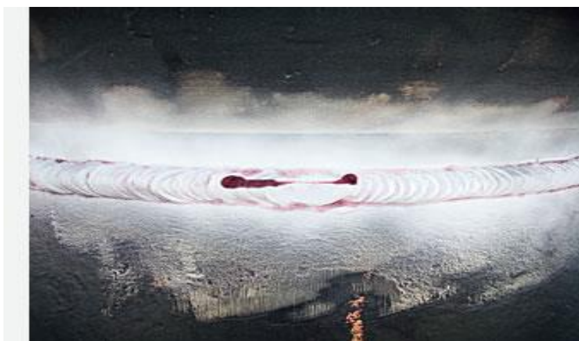
Слика 14. Пенетрант у боји на завареном споју (јасно се види површинска прслина; завар није добар)
