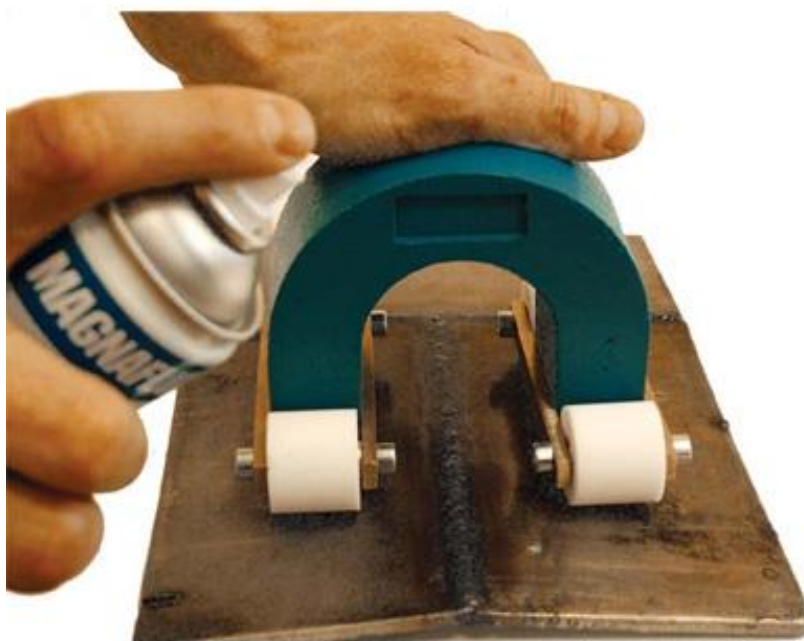
Слика 10. Коришћење перманентног магнета за испитивање завареног споја
