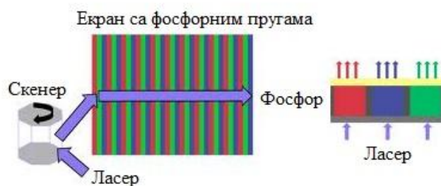
Слика 7.11 Шематски приказ фосфора за телевизоре високе резолуције
