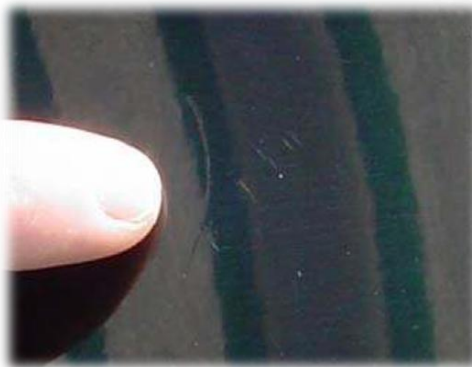
Слика 7.5 Огреботина која се отклања нанобојама
