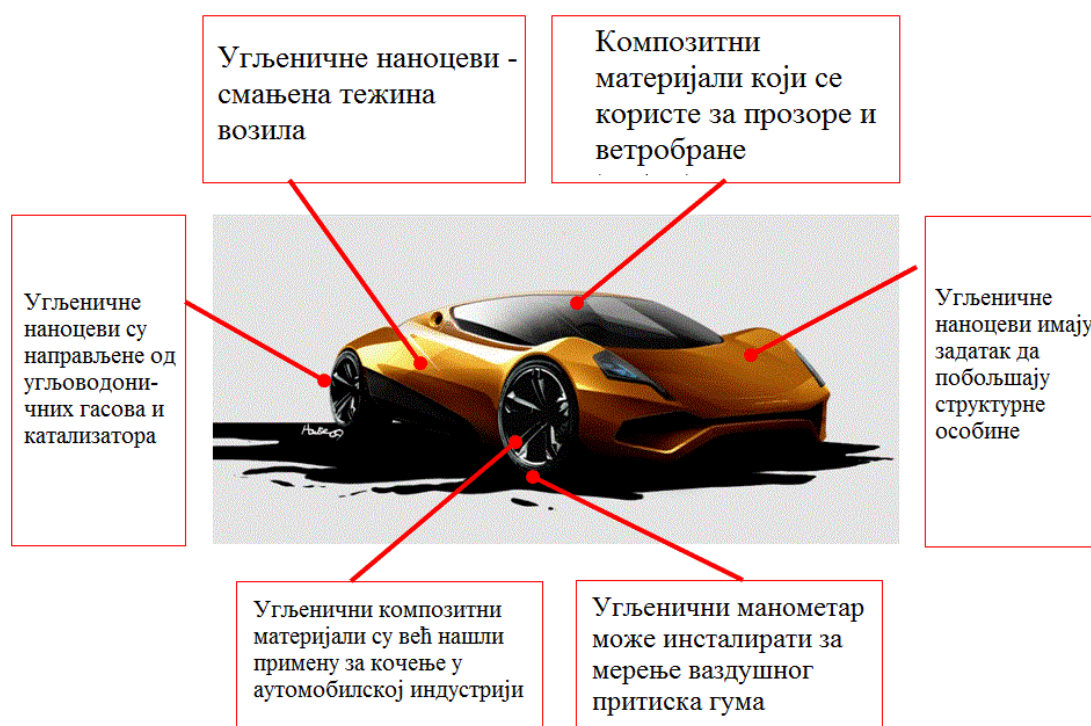
Слика 7.6 Примена наноцеви и композитних материјала у аутоиндустрији
