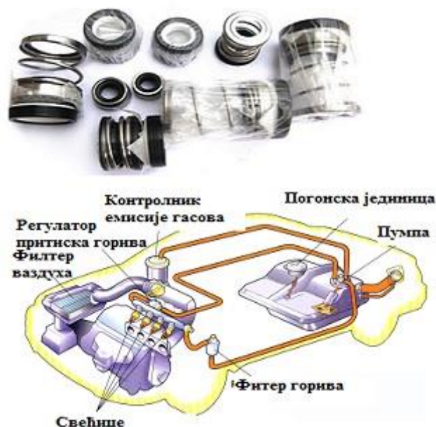
Слика 2.34 Примена POM-а на манжетни (горе) и PUR-а (систем за довод горива) [40]
