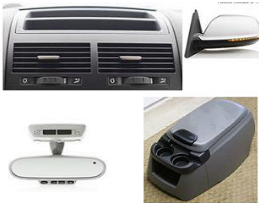
Слика 3.8 Примена акрилонитрил бутадиен стирена на аутомобилу [19]
