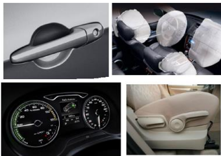
Слика 3.5 Примена полиамида у ентеријеру аутомобила [19]
