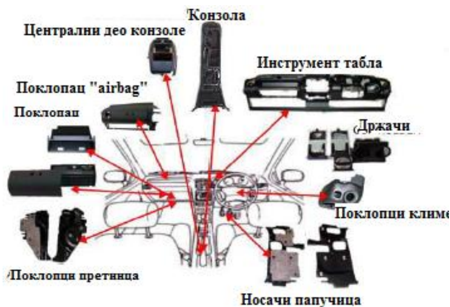
Слика 3.7 Примена полипропилена у ентеријеру аутомобила[19]
