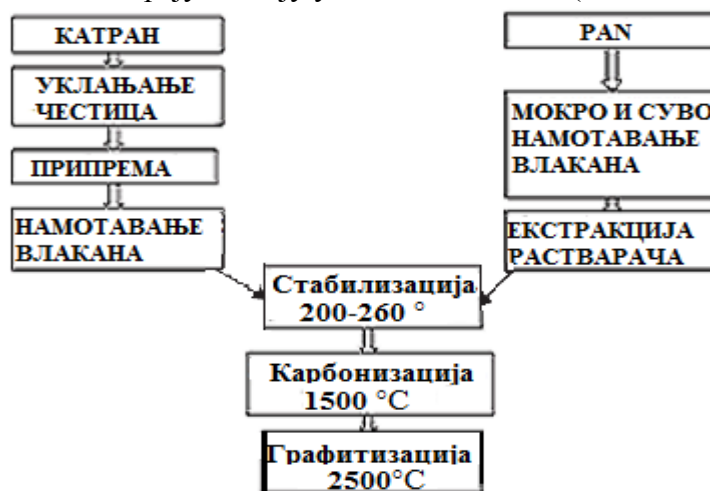
Слика 3.10 Процес добијања угљеничних влакана [4]
