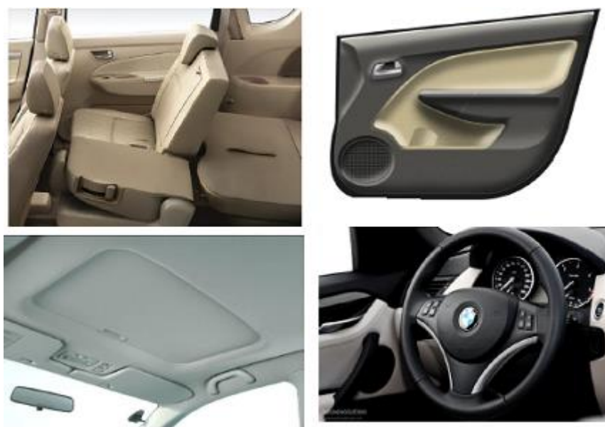
Слика 3.6 Примена полиуретана у ентеријеру аутомобила [19]
