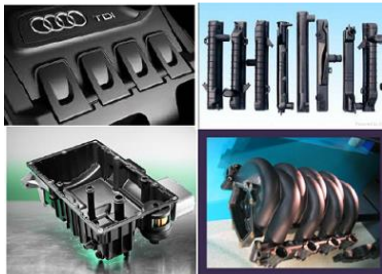
Слика 3.4 Примена полимерних материјала на компонентама агрегата [19]
