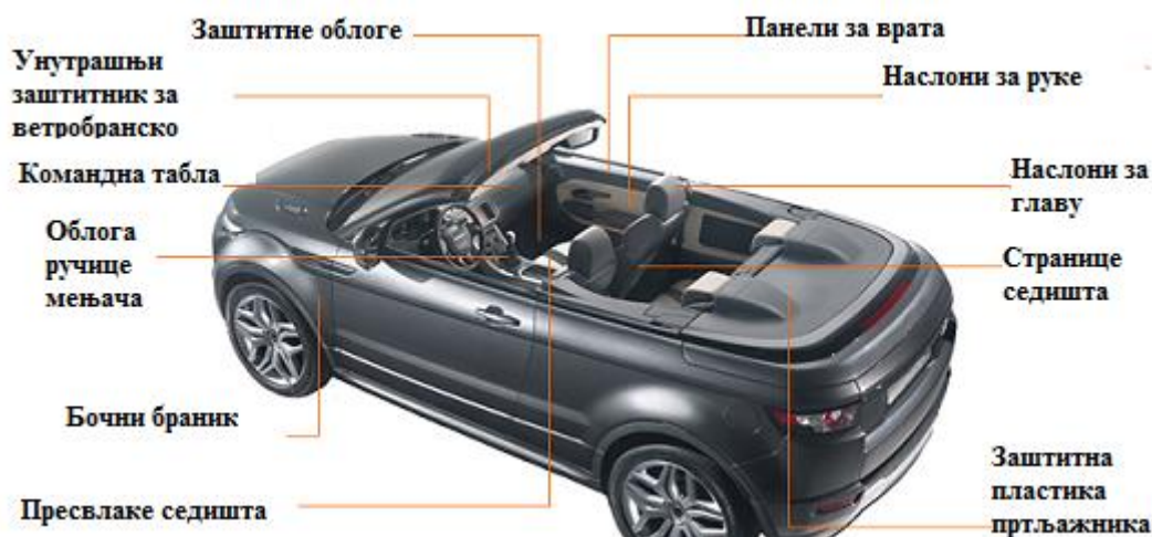
Слика 2.27 Приказ примене поливинил хлорида у ентеријер возила [26]
