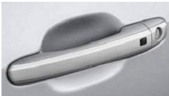
Слика 2.35 Примена полибутилен терафталата [41]
