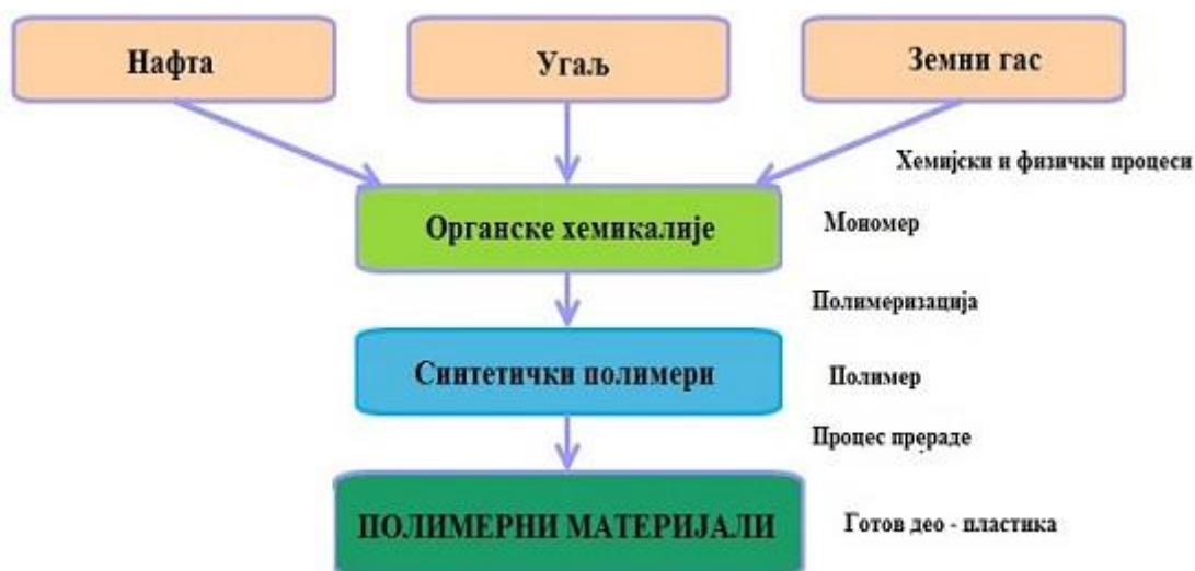
Слика 2.10 Шематски приказ процеса добијања полимерних материјала [29]
