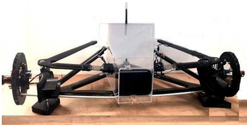
Слика 3.12 Приказ система ослањања и управљања на предњем делу формуле [21]
