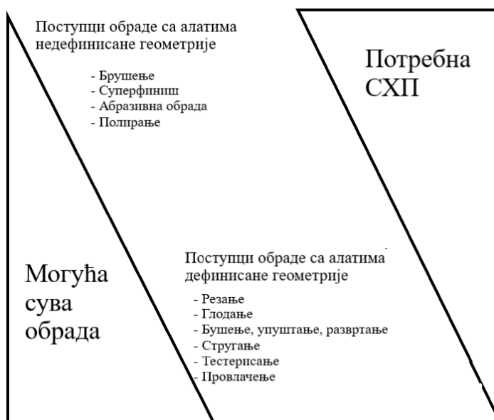
Слика 2.3. Зависност коришћења СХП – а и начина обраде [10]
