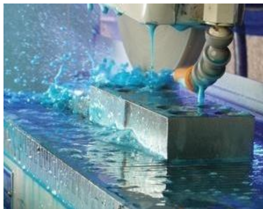
Слика 4.6. Брушење са наношењем СХП - а. [47]
