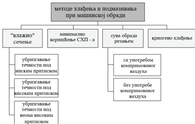
Слика 3.1. Методе хлађења и подмазивања при машинској обради резањем [20]
