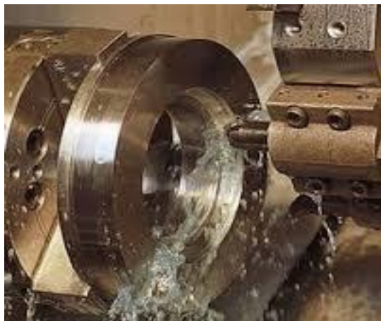
Слика 4.3. Стругање са употребом СХП – а [44]
