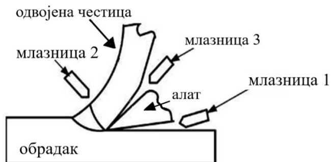
Слика 2.6. MQL обрада са добављањем СХП-а помоћу три млазнице [17]
