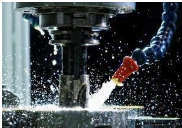
Слика 4.5. Бушење са применом СХП - а. [46]
