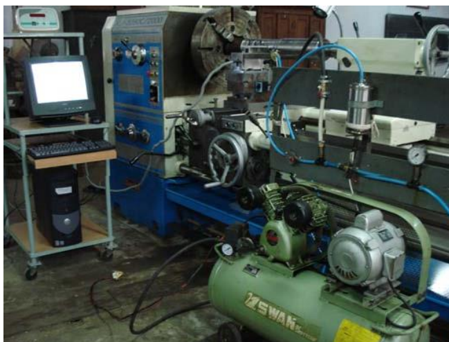
Слика 5.2. Пример постављања система за довођење MQL – а [56]
