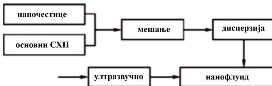
Слика 4.2. Блок дијаграм припреме методе „два корака“ [32]
