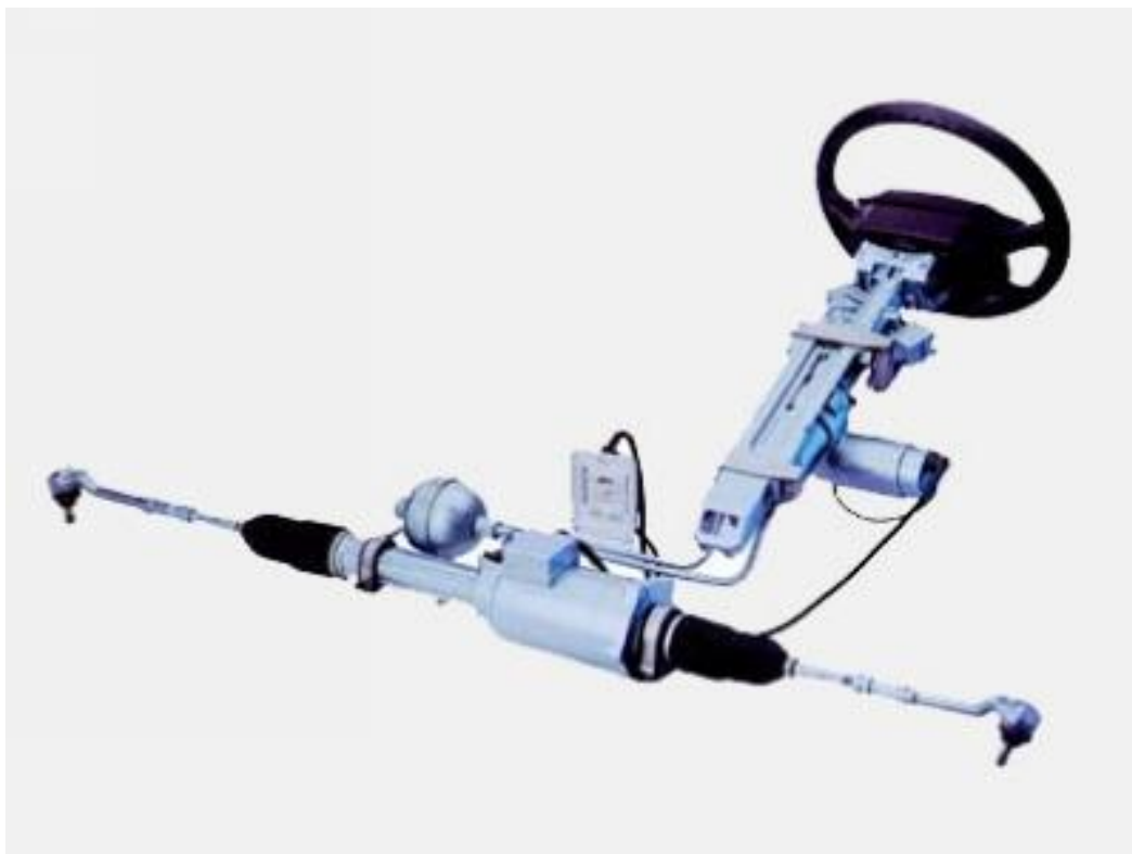
Слика 6.4: "Steer by wire" систем за управљање [5]
