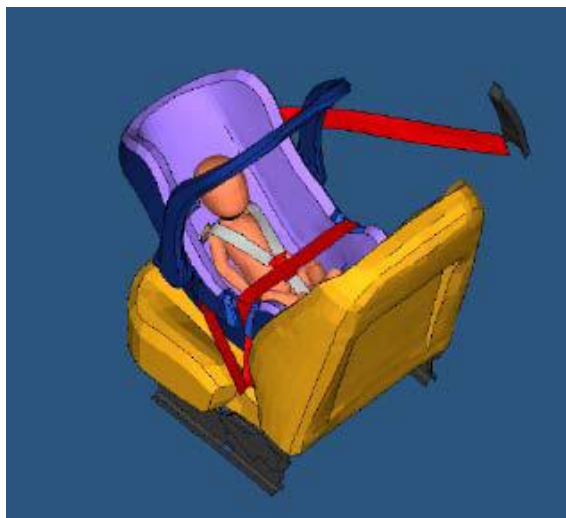
Слика 30 - Модел Q0 и CRS пре почетка crash-теста; реална слика и компјутерски модел
