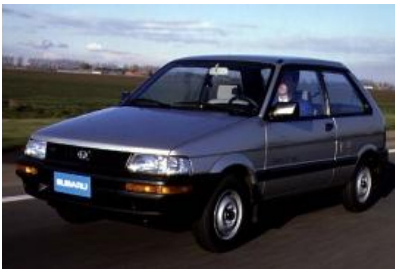
Слика 24. Subaru Justy први амерички путнички аутомобил опремљен комбинованом континуалном трансмисијом
