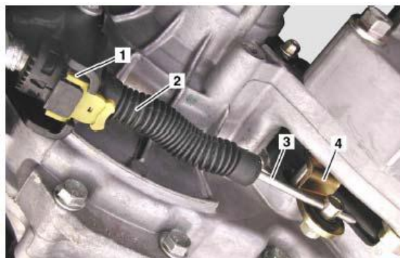
Слика 46. Сајла избора степена преноса
