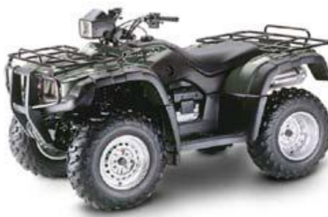
Слика 12. Хонда Рубикон са хидростатичком трансмисијом
