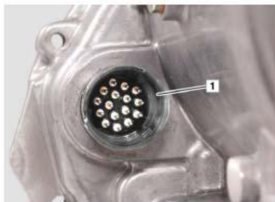
Слика 47. Кружни конектор
