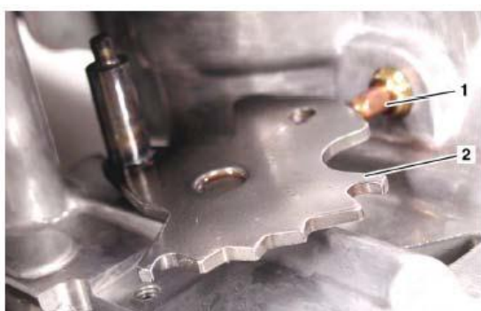
Слика 43. Селекторски механизам
