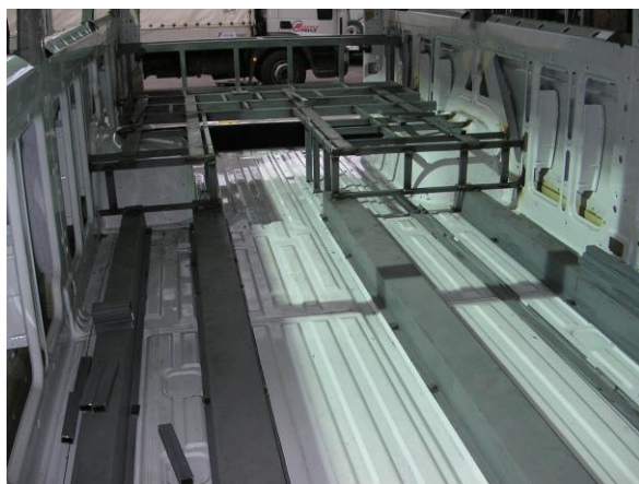
а) б) Слика 33. Пример заварене конструкције издигнутог пода
