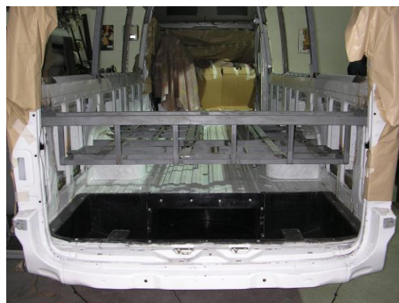
а) б) Слика 33. Пример заварене конструкције издигнутог пода
