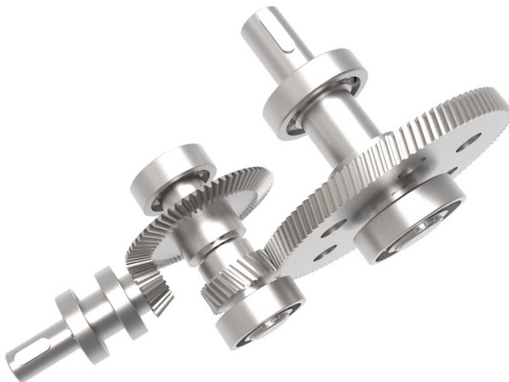
Слика 4.21. 3D модел елемената редуктора прорачунатих у Autodesk Inventor-у
