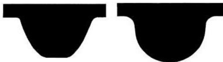
Слика 3.5 –Трапезни и криволинијски профил зуба
