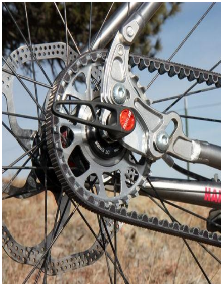
Слика 3.16 – Примена зупчастих каишева код бицикли и мотоцикала
