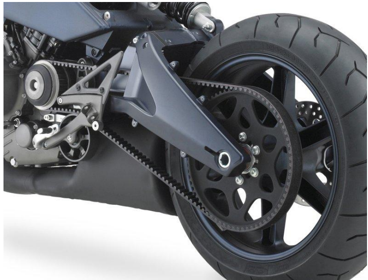
Слика 3.16 – Примена зупчастих каишева код бицикли и мотоцикала
