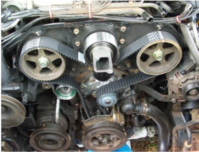
Слика 3.15 – Примена зупчастих каишева код мотора са унутрашњим сагоревањем
