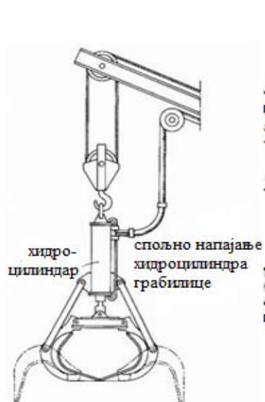
Слика 4.9. Спољно напајање хидрауличке грабилице [10]
