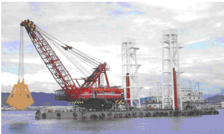
Слика 4.22. Изглед грабилице са два ужета на пловном објекту [10]
