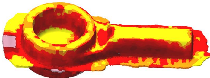
Слика 6.16 Температура готовог отковка (поглед 1)
