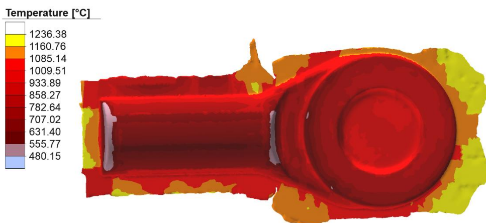
Слика 6.37 Температура готовог отковка (поглед 2)
