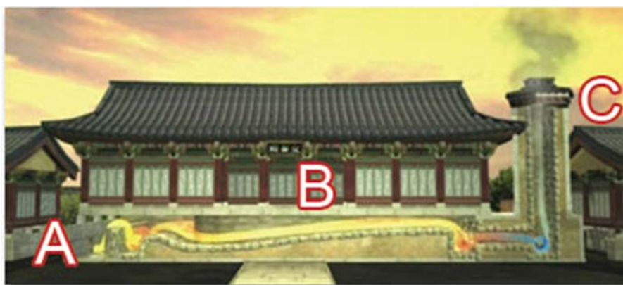
Слика 2.3. Приказ “ ondol ” система грејања [5]
