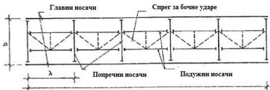
Слика 4.5. Шематски приказ коловозних и главних носача (са спрегом за пријем бочних удара) за једноколосечни отворени коловоз [5]
