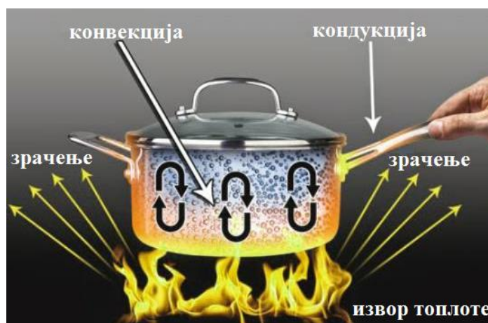
Слика 27. Механизми преношења топлотне енергије [6]
