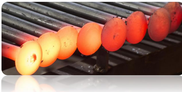
Слика 29. Загревање предмета до усијања које је видљиво голим оком [5]
