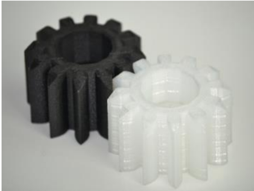
Слика 4.2. Композитни зупчаник
