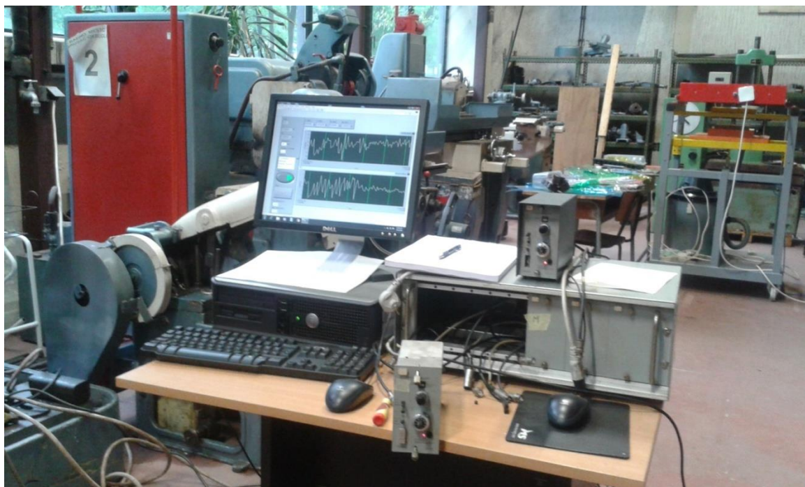
Слика 32. Пиезо појачивач и рачунар коришћени за мерење отпора резања
