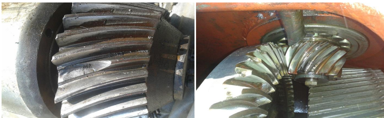
Слика 3.15. Зупчаници редуктора – улазни парови
