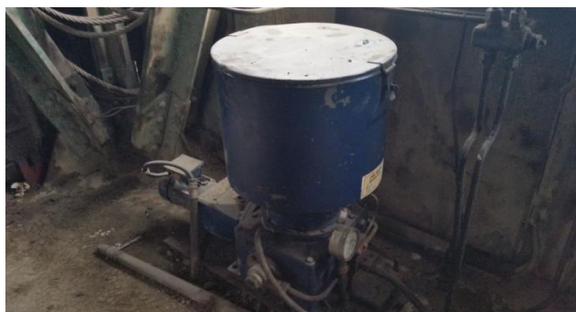
Слика 4.6. Пумпа за прогресивно подмазивање
