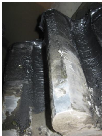
Слика 5.12. Неравномерно подмазивање зубаца услед запушености отвора зупчаника за подмазивање
