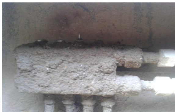
Слика 4.12. Распоредник система за подмазивање
