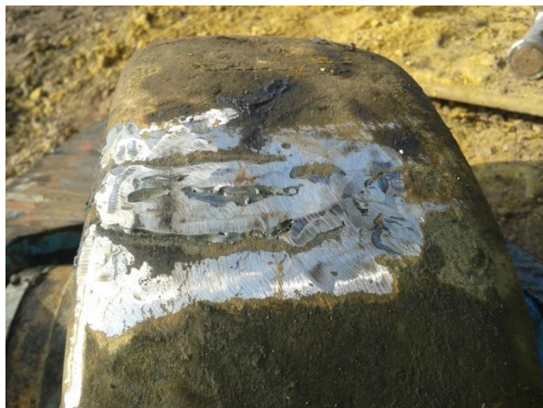
Слика 3.21. Носећи тркач возног механизма багера
