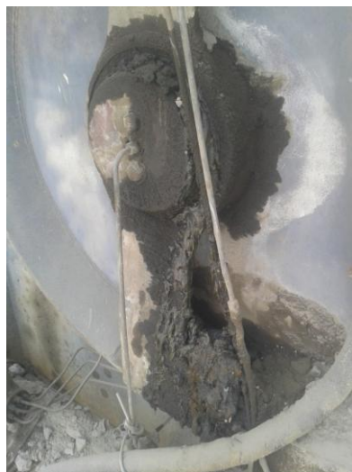
Слика 4.10. Клизни лежај на улежиштењу траке три
