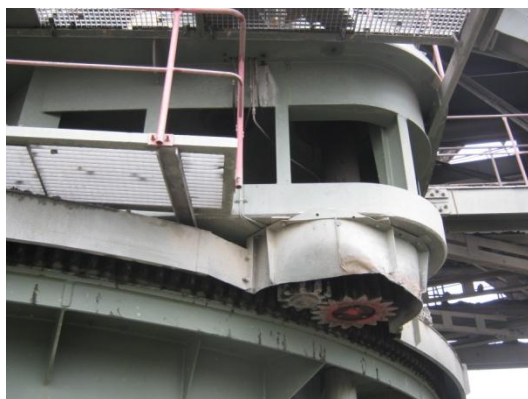
Слика 5.11. Подмазивање уз помоћ зупчаника за подмазивање одлагача О-8500
