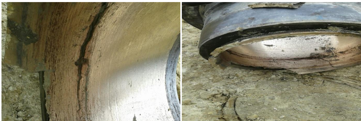
Слика 3.8. Клизни лежај вертикалног вратила кружног кретања
