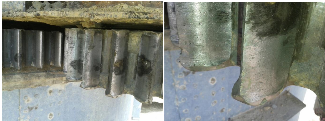
Слика 5.14. Зуби зупчаника кружног кретања багера
