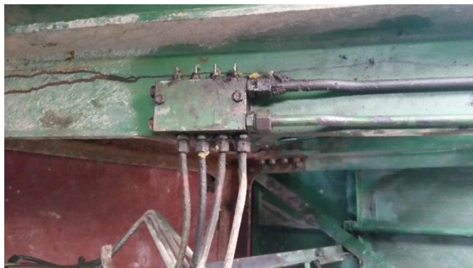
Слика 4.8. Дозатор прогресивног система подмазивања
