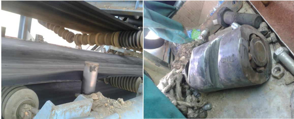
Слика 3.19. Ролница за усмеравање траке за пренос материјала
