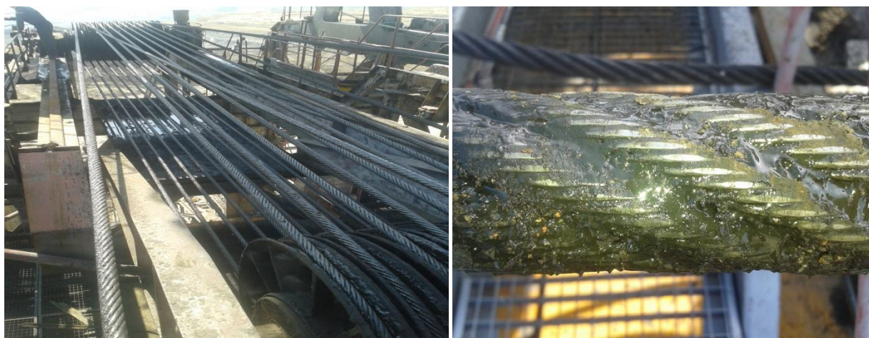
Слика 3.3. Ужад дизања и спуштања стреле радног точка роторног багера
