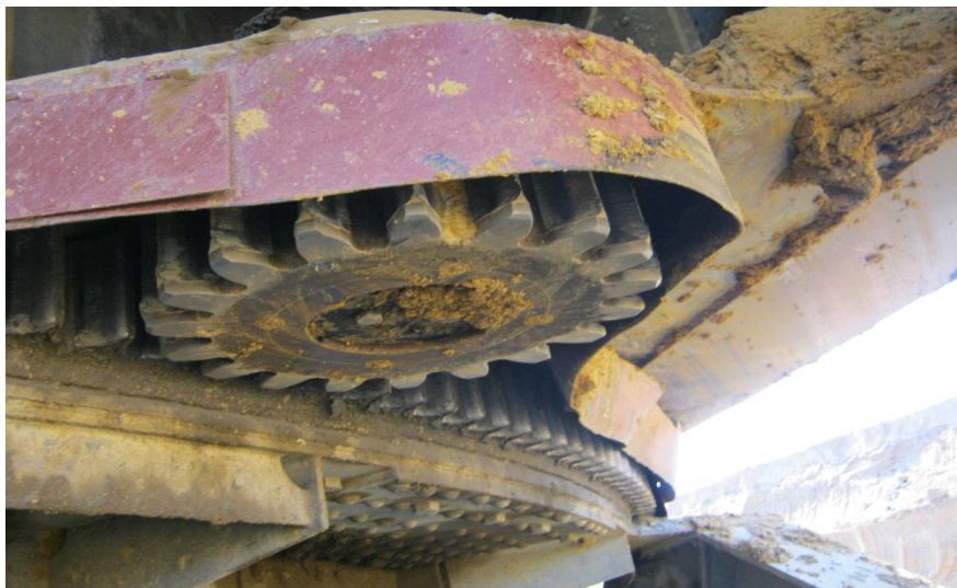
Слика 5.8. - Стање погонског зупчаника и озубљеног венца Г-4, SRs 1200
