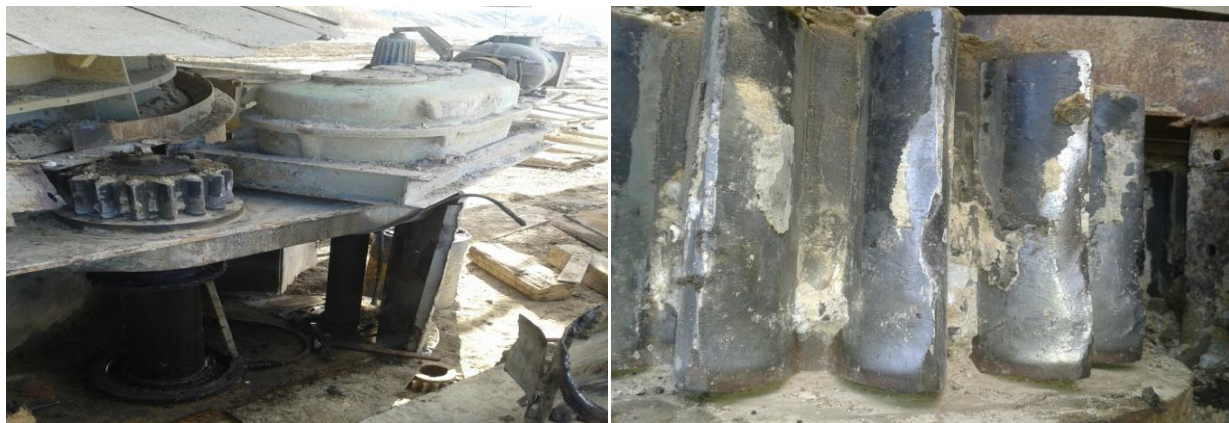
Слика 3.17. Зупчаник за покретање кружног кретања одлагача
