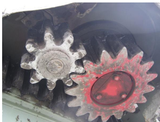
Слика 5.11. Подмазивање уз помоћ зупчаника за подмазивање одлагача О-8500
