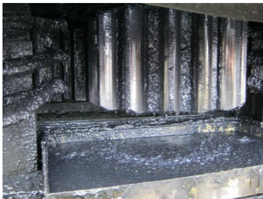
Слика 5.10. Претерано подмазивање погонског зупчаника Г-3 на Тамнави Западно поље
