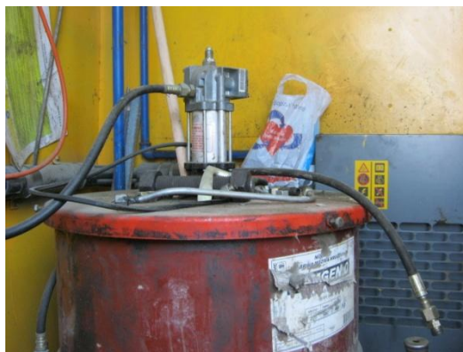
Слика 5.9. Пнеуматска пумпа са буретом на Г-2 са поља „Д“
