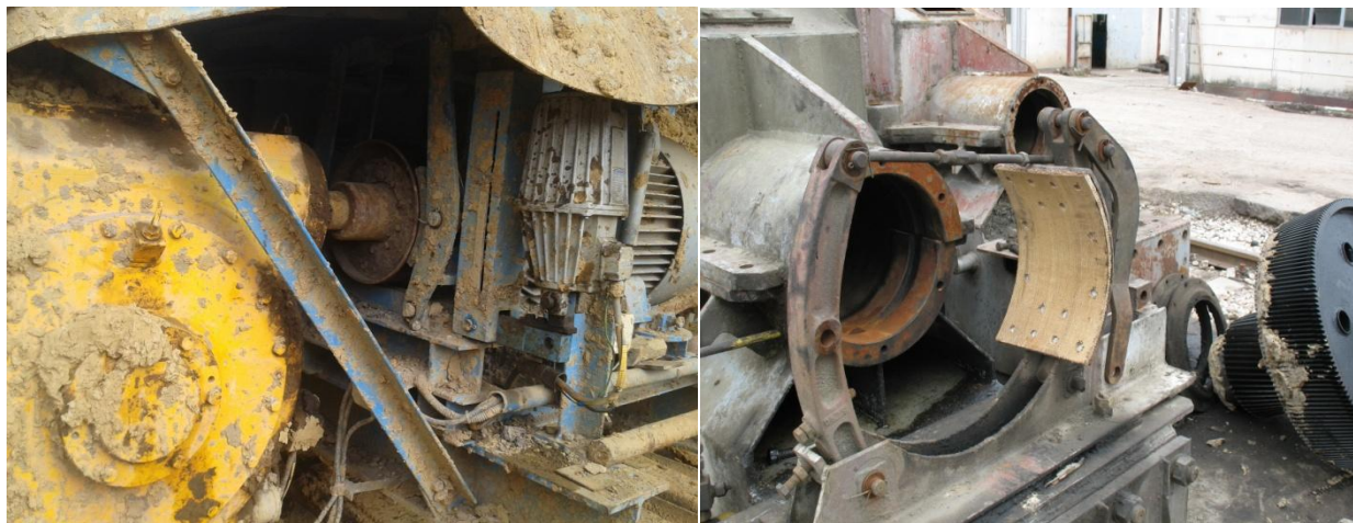
Слика 3.6. Кочиони механизам редуктора транспорта багера
