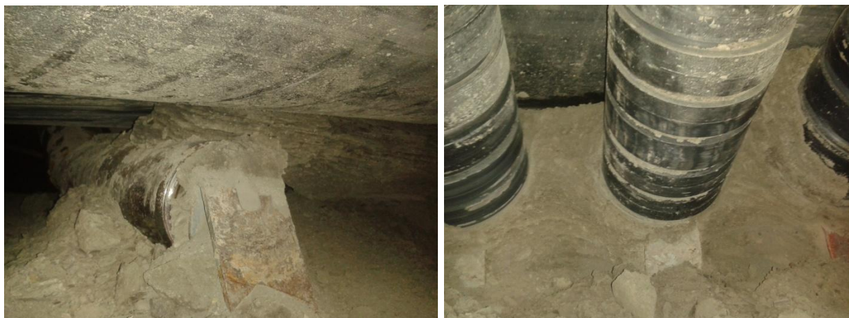
Слика3.1. Транспортни ваљци траке за транспорт јаловине
