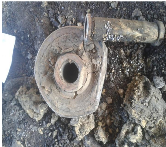
Слика 3.20. Тркач гусеничног возног механизма багера
