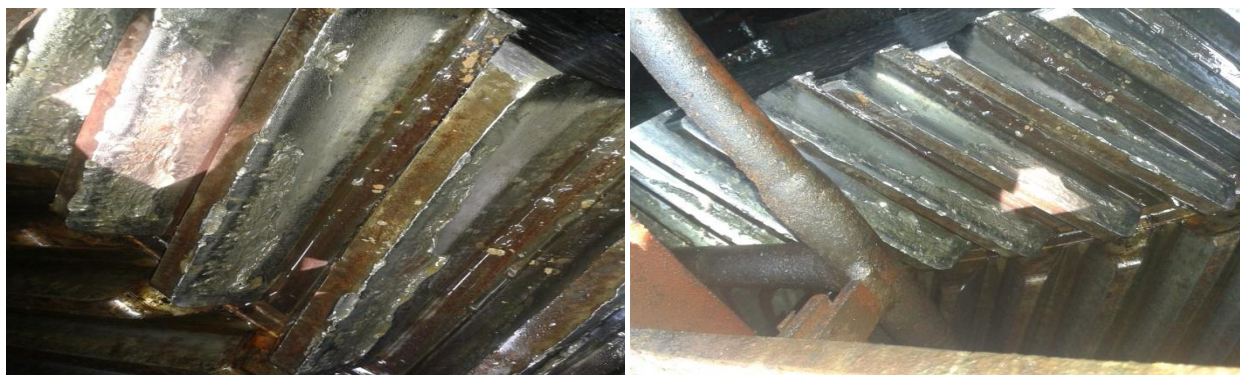
Слика 3.16. Оштећени зуби зупчаника редуктора погона траке
