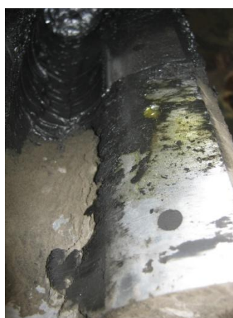
Слика 5.12. Неравномерно подмазивање зубаца услед запушености отвора зупчаника за подмазивање
