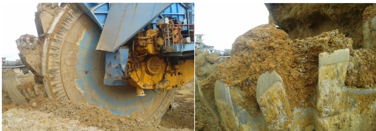
Слика 3.22. Кашика радног точка багера са зубима
