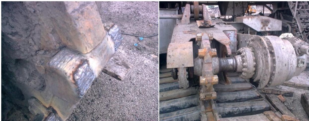
Слика 3.24. Погонски сегменти за гусенички механизам багера
