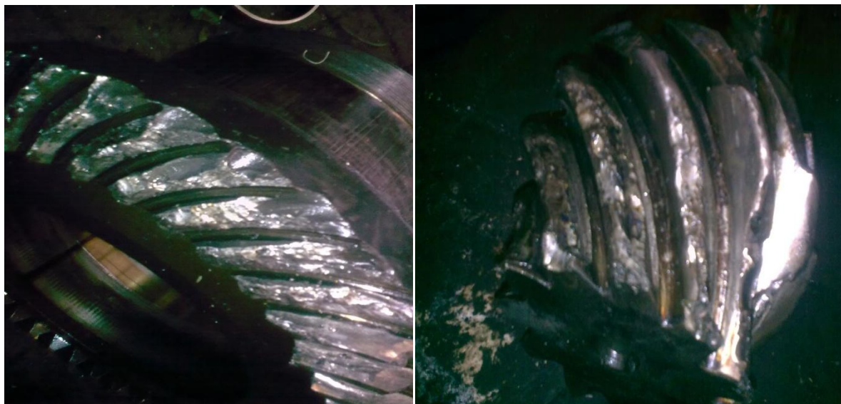
Слика 3.18. Конусни и тањирасти зупчаник редуктора копања
