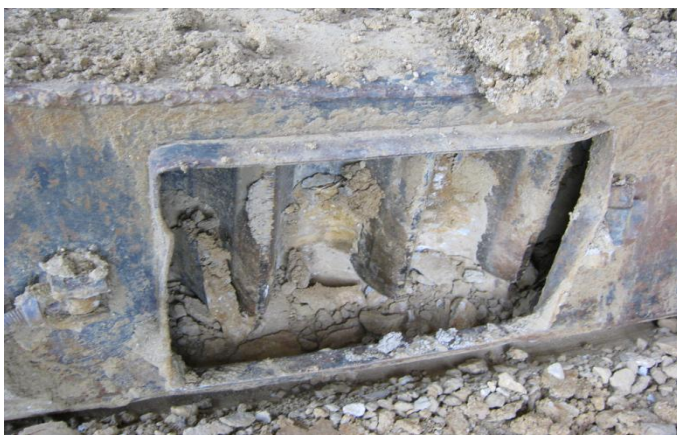
Слика 5.7. Озубљени венац за кружно кретање горње градње Г-4, SRs 1200, са поља „Д“
