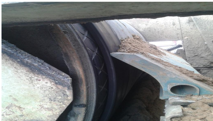
Слика 3.5. Брисач траке за транспорт угља и јаловине
