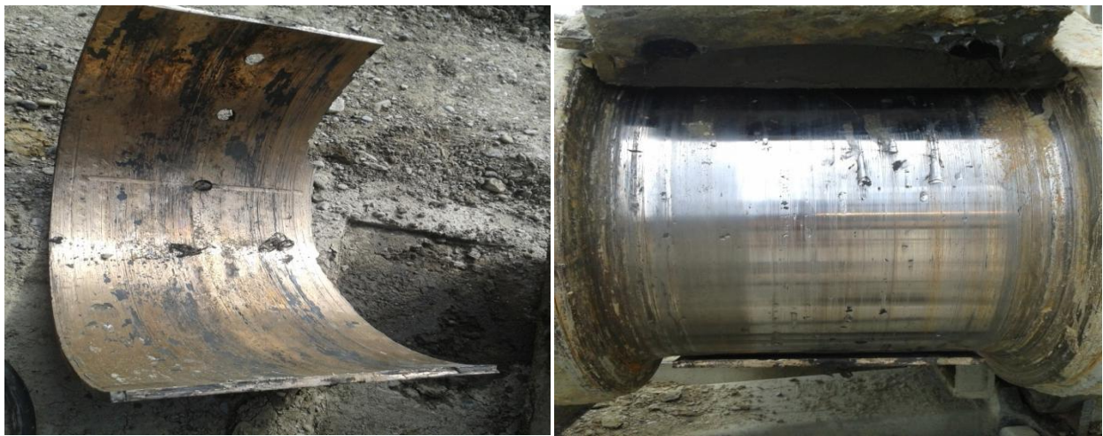
Слика 3.7. Клизни лежај погонског вратила гусеничног механизма( а, б)
