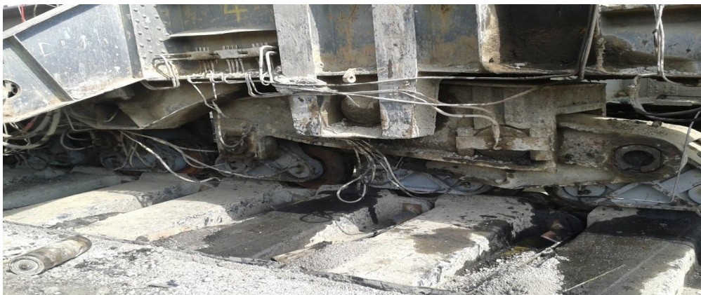
Слика 4.5. Прогресивни систем подмазивања возног механизма багера
