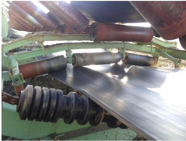
Слика 3.4. Усмеривач повратног дела транспортне траке
