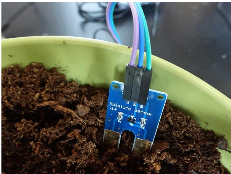
Слика 2 – Постављање сензора [6]
