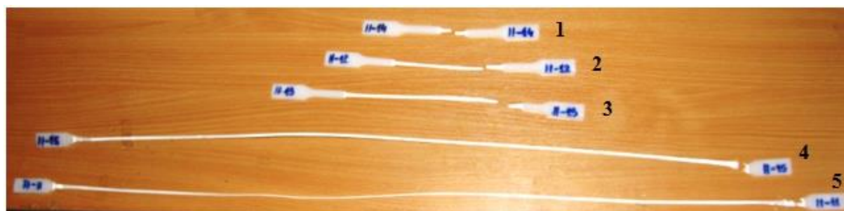
Слика 8.15 Изглед епрувета након кидања испитиваних на собној температури
