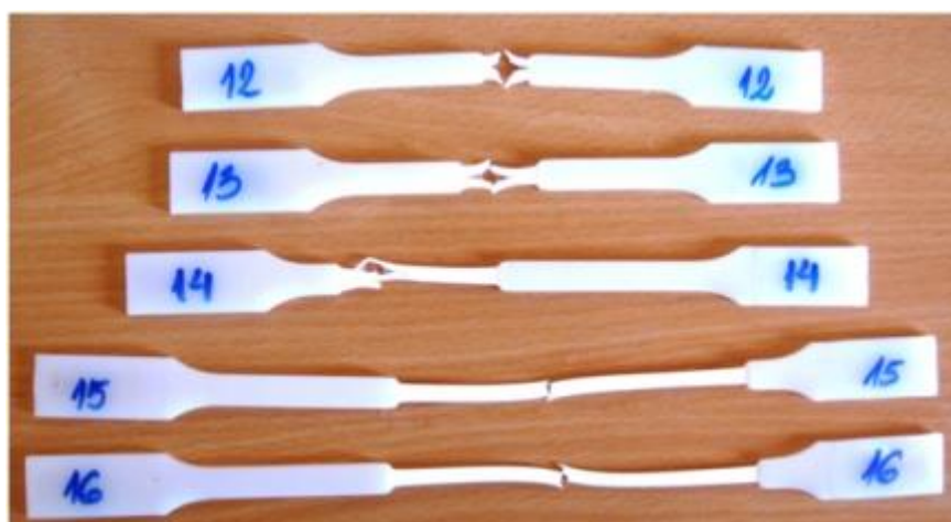
Слика 8.13 Изглед епрувета након кидања при температури од 0^{\circ}\text{C}
