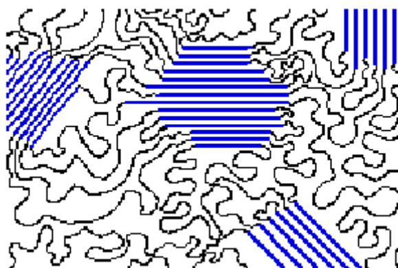
Слика 4.4 Шематски приказ кристалних и аморфних подручја у полиетилену
