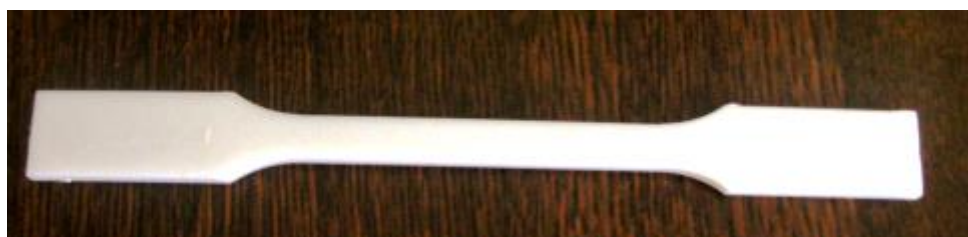
Слика 8.4 Изглед епрувете за испитивање
