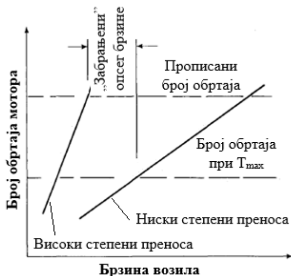
Слика 24. Веза између броја обртаја мотора и брзине возила при различитим преносним односима [13]
