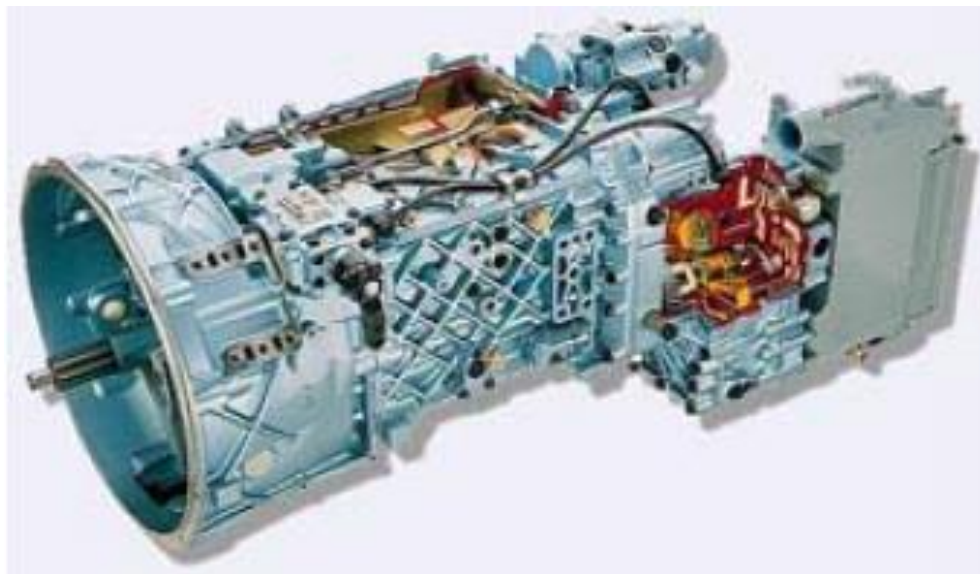
Слика 17. Спољашњи изглед мењача тешких теретних возила 16S221 произвођача ZF [7]
