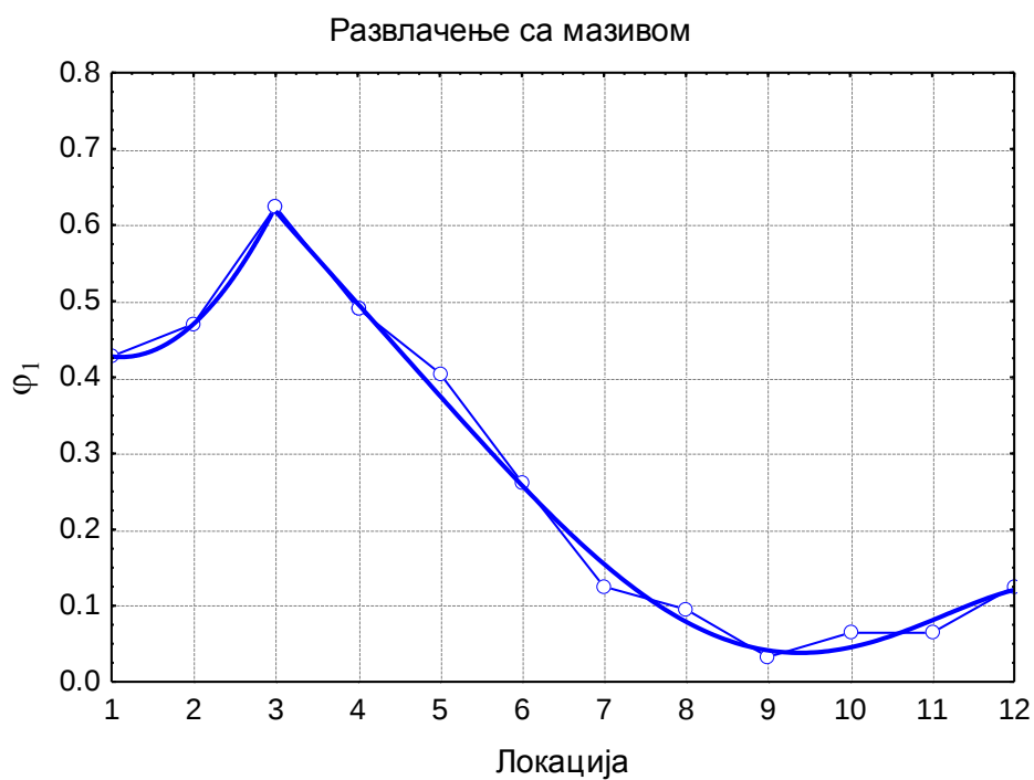
Слика 4.38 Дијаграм дистрибуције деформација \varphi_1 при развлачењу полусферним извлакачем са мазивом
