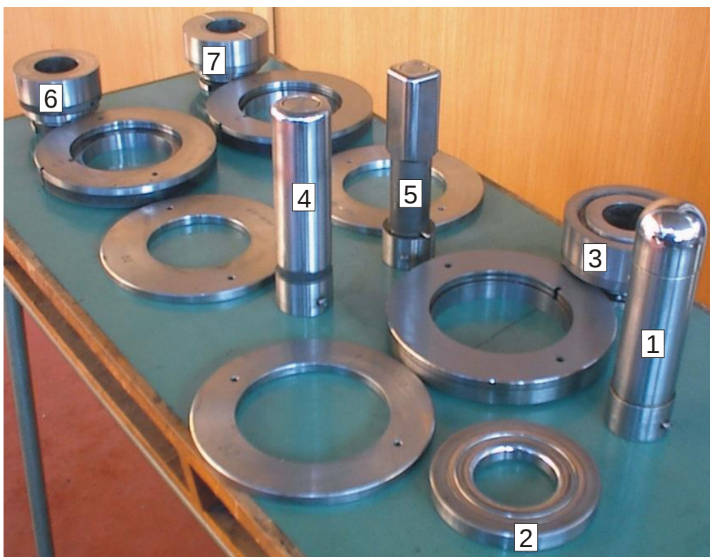
Слика 4.27 Неки елементи алата за развлачење и дубоко извлачење
