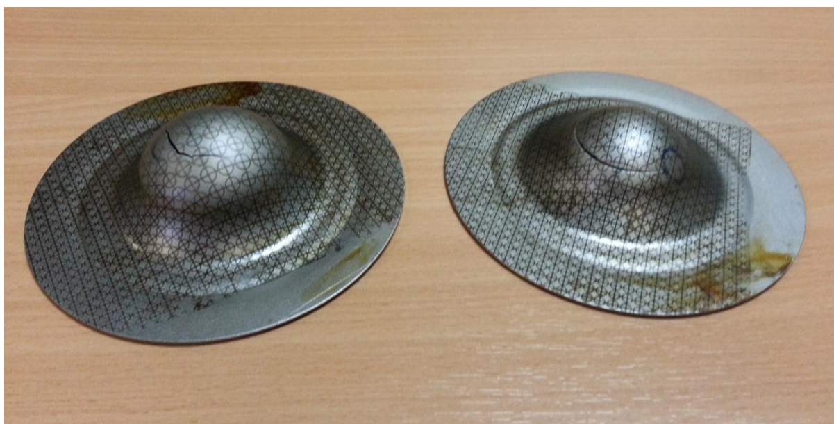
Слика 4.41 Епрувете након разарања при развлачењу полусферним извлакачем без (десно) и са коришћењем мазива (лево)
