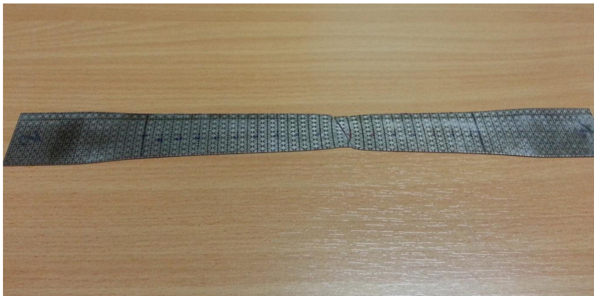
Слика 4.34 Епрувета након разарања при једноосном затезању
