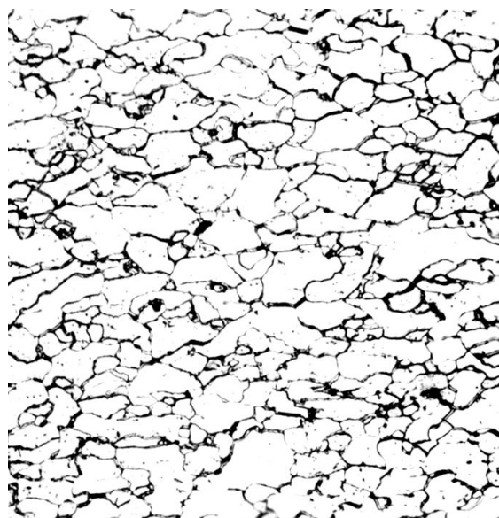
Слика 4.30 Изглед микроструктуре за челични лим (увећање 100\times )
