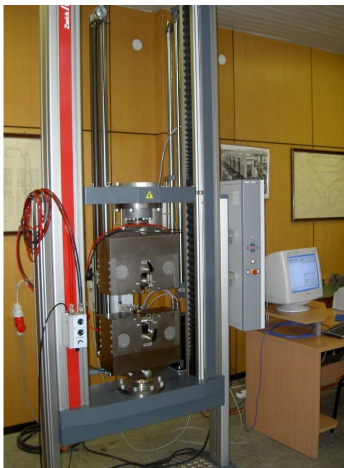
Слика 4.5 Мерни систем Zwick/Roell Z100
