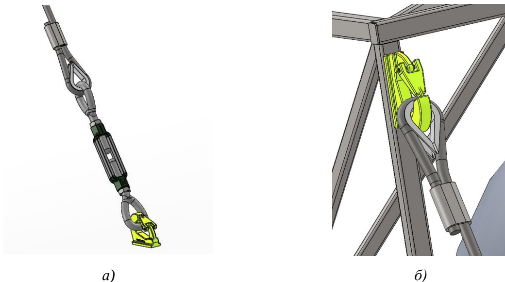
Слика 6.7. Причвршћивање ужета за подлогу и решеткасту конструкцију
