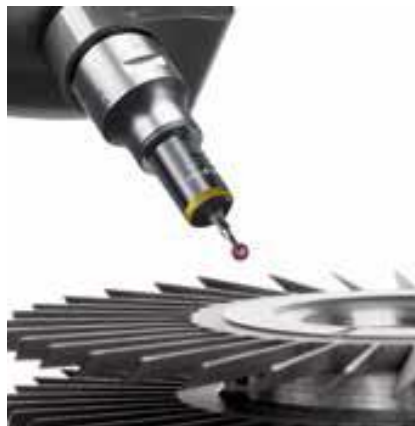
Слика 8. Сонда са мерним пипком TESASTAR-mp .
