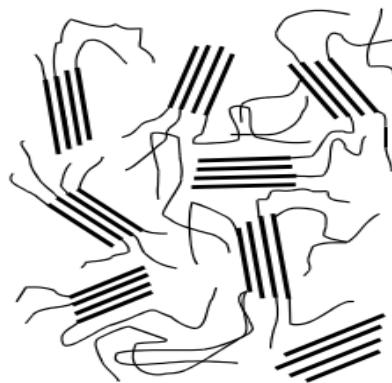
Слика 2.4. Делимично кристална структура
