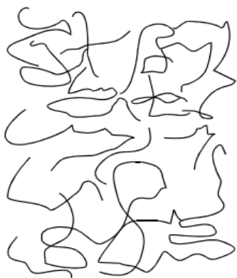
Слика 2.3. Приказ аморфне структуре
