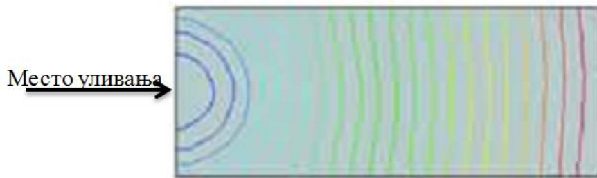
Слика 4.18. Попуњавање калупне шупљине за случај када је уливак на крају дела [10]
