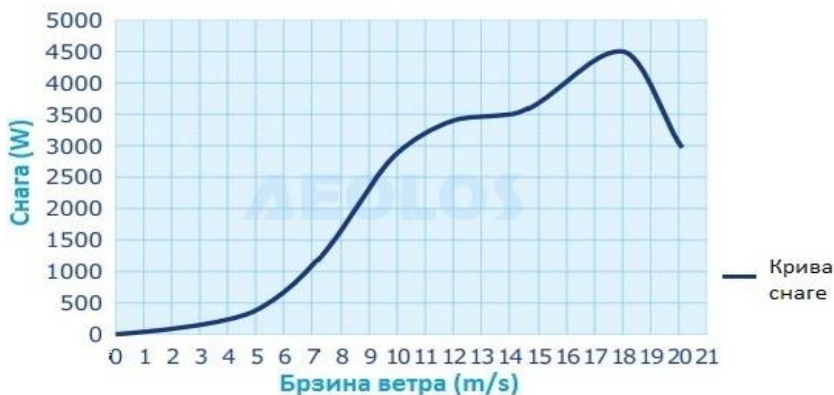
Слика 4.14. Зависност снаге од брзине ветра за модел „Aeolos-H 3kW“ ветрогенератора
