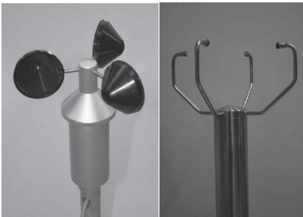
Слика 2.7. Анемометар са лопатицама (лево) и ултразвучни анемометар (десно)
