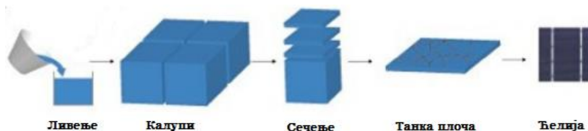
Слика 3.5. Поступак добијања поликристалних силицијумских ћелија
