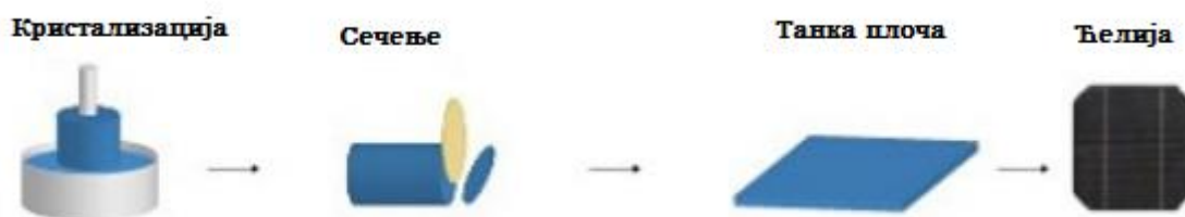
Слика 3.4. Поступак добијања монокристалних силицијумских ћелија
