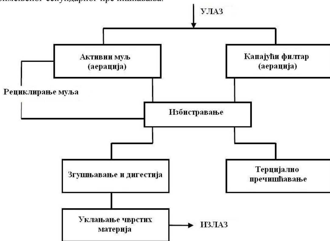
Слика 2.2.3 Упрошћена шема секундарног пречишћавања отпадних вода [5]
