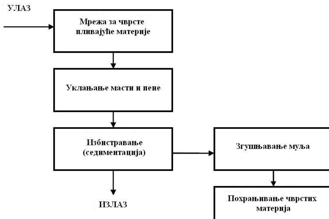
Слика 2.2.2 Упростијена шема примарног пречишћавања отпадне воде [5]
