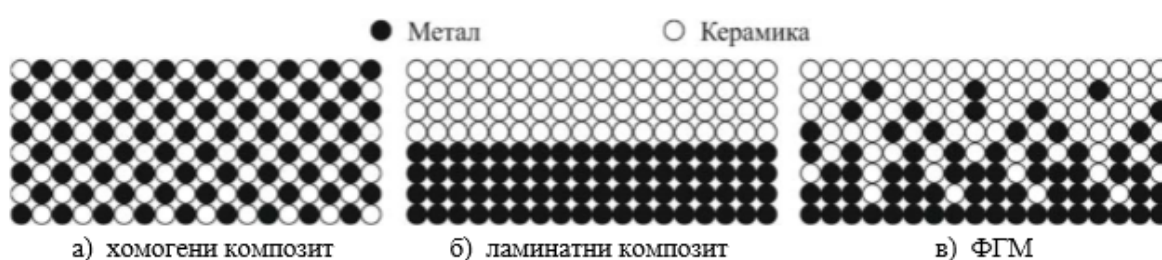
Слика 28. Хомогени и ламинатни композит у односу на ФГМ [20]
