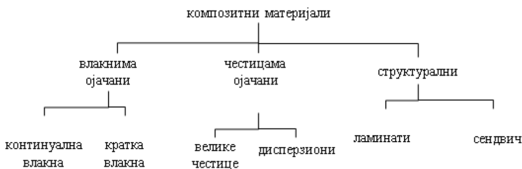
Слика 14. Подела композитних материјала по типу ојачања [5]
