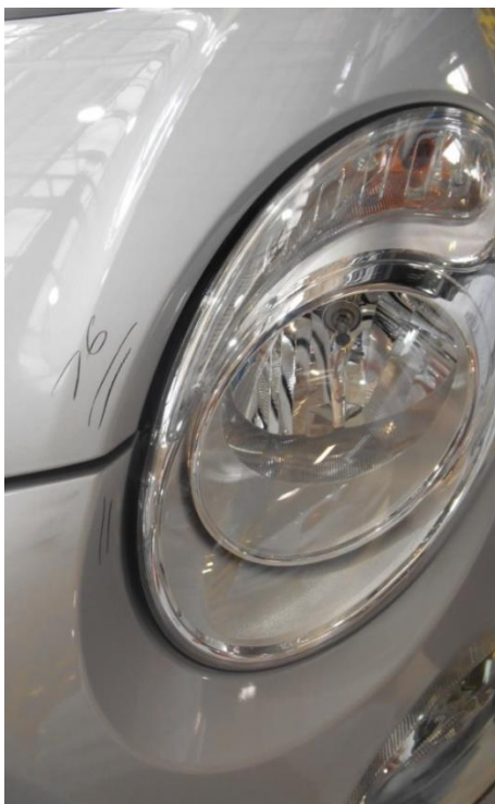
Слика 9. Увећан зазор између фара и браника
