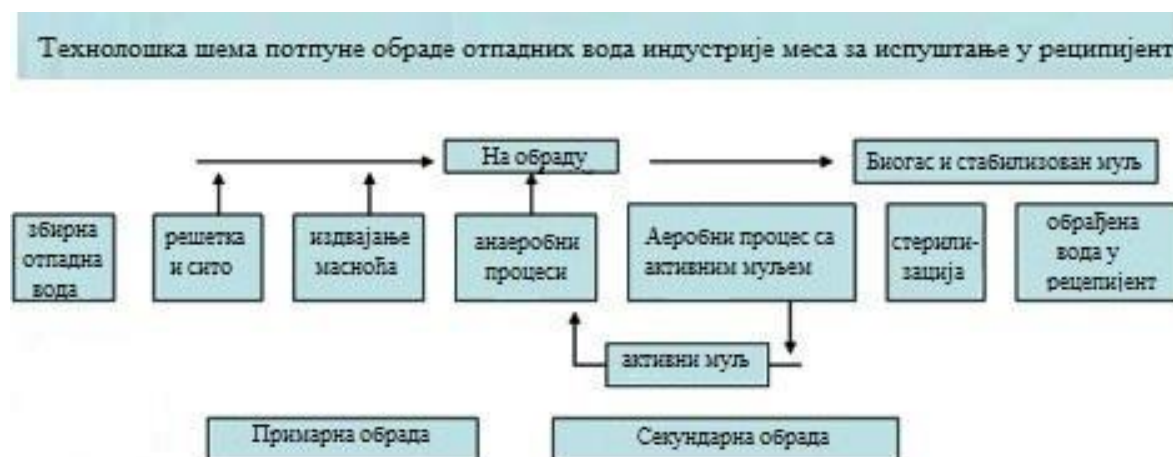
Слика 23. Технолошка шема потпуне обраде отпадних вода клиничне индустрије за испуштање у реципијент [12]
