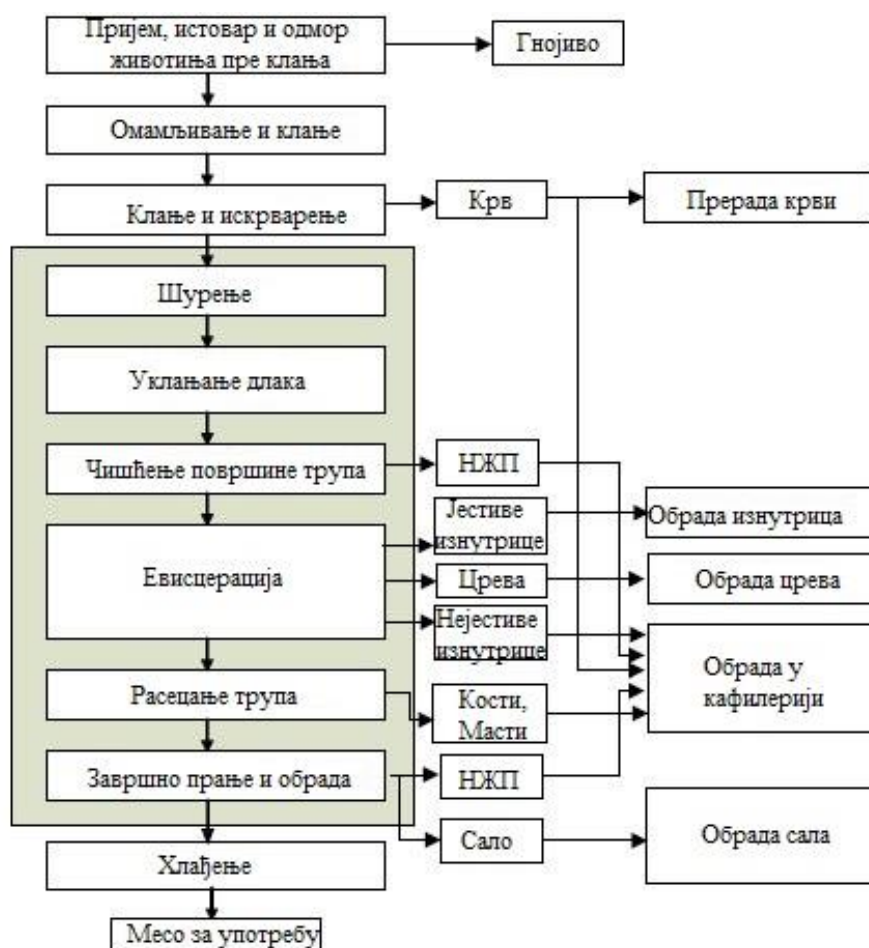
Слика 4. Шематски приказ технолошког процеса клања свиња [10]
