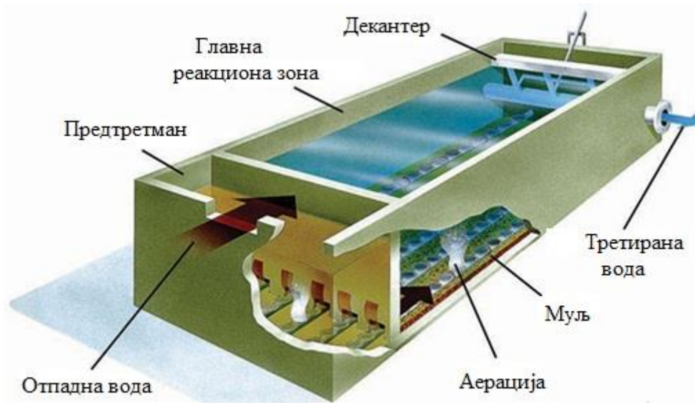
Слика 13. Пример биолошког третмана (аерациони базен) [1]
