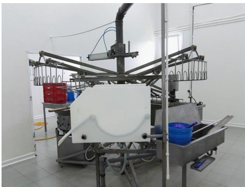
Слика 34. Уређај где се врши клање и обрада живине
