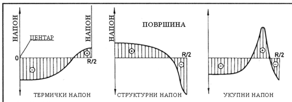
Слика 4.1 Распоред термичких и структурних напона при хлађењу [3, 4]
