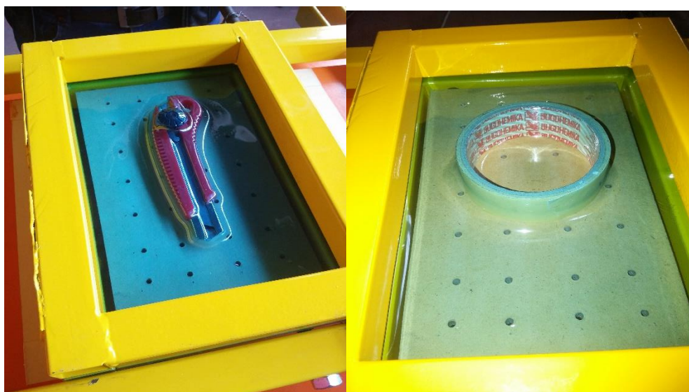
Слика 7.5 вакум плоча у току процеса добијања амбалаже
