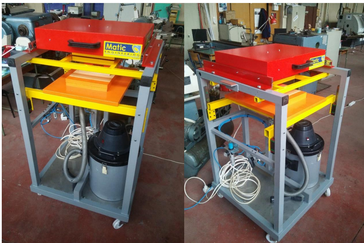
Слика 7.1 машина за вакуум-термообликовање
