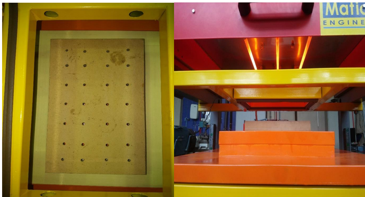
Слика 7.4 модификована вакуумска плоча
