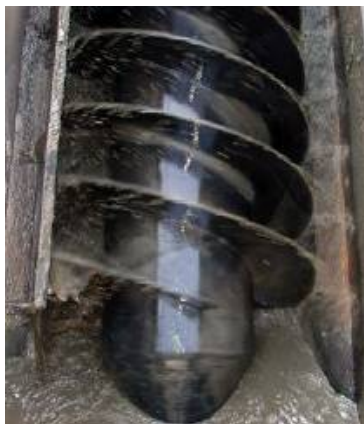
Слика 43. Пужна пумпа за циркулацију муља[22]
