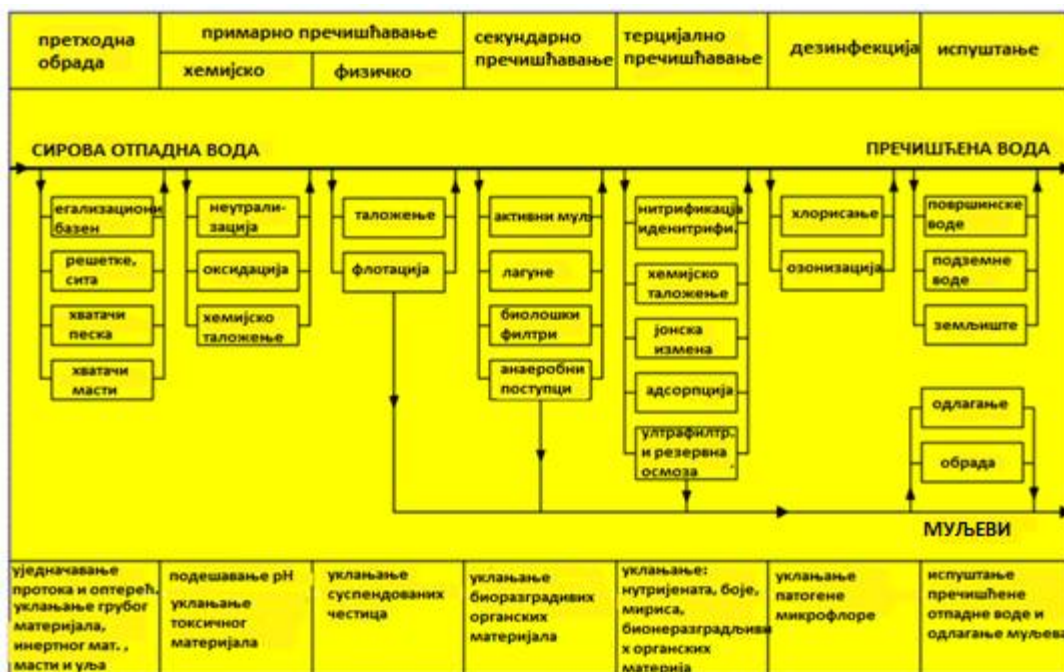
Слика 21. Фазе процеса пречишћавања и опције извођења [13]
